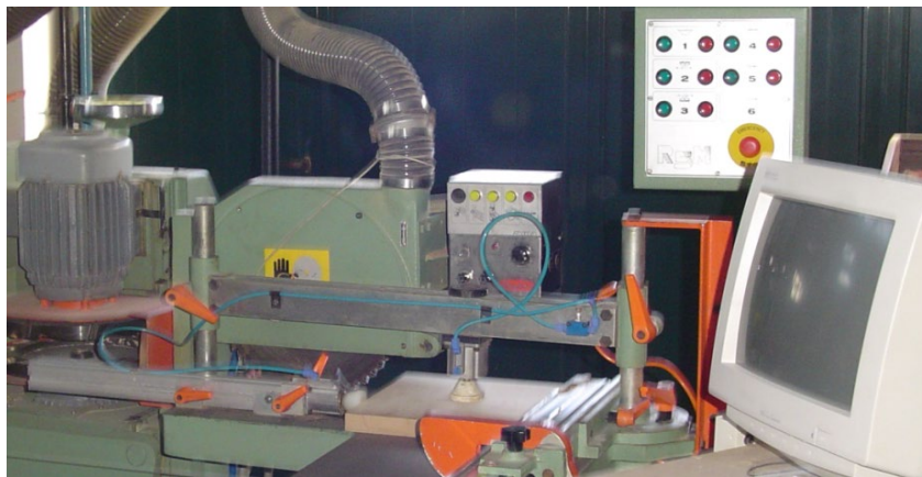
Figura 4.6 – Máquina MIDA R5M instrumentada (Coelho et al. , 2011; Garrido et al. , 2008, 2007a, b)
