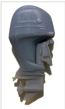
Figura 8. Impressão 3D do motor da embarcação através da tecnologia PolyJet.
