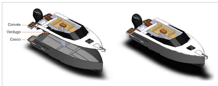
Figura 2. Casco, convés e verdugo de uma embarcação de recreio.
