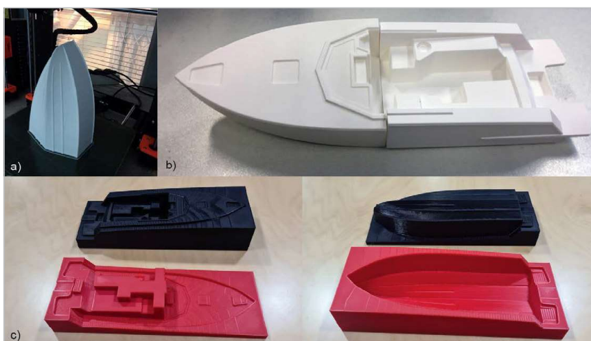
Figura 7. Impressão 3D por extrusão de filamento fundido da embarcação em duas partes separadas, à escala 1:20 (a e b) e dos moldes à escala 1:40 (c).
