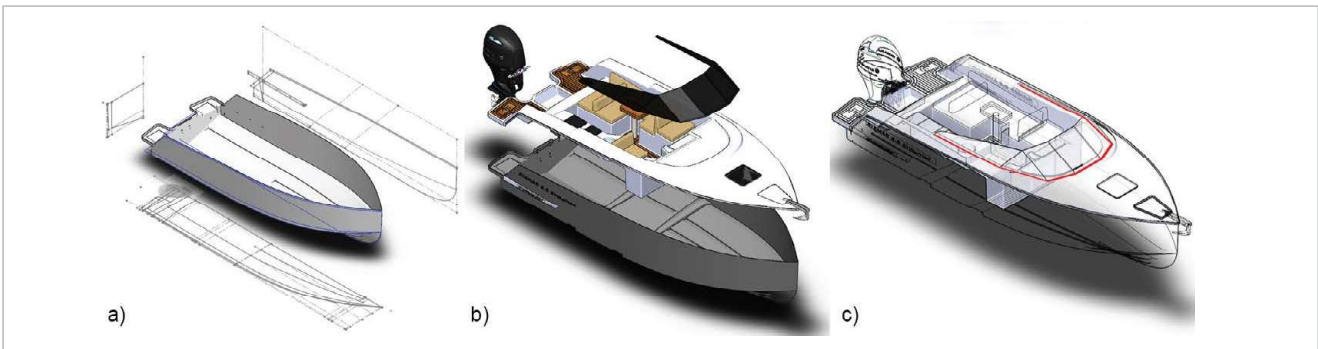
Figura 4. Processo de modelação 3D em Solidworks: a) modelação individual dos componentes; b) montagem dos componentes; c) análise de interferências e folgas dos diversos componentes.
