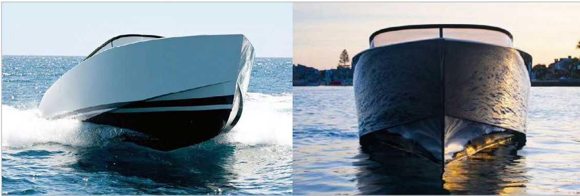
Figura 3. Embarcação VanDutch 30 e o seu casco em forma de V com efeito tulipa [7].
