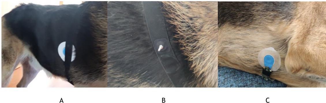
Figura 14 - Posicionamento dos eléttodos, banda e VitalSticker nos testes. A - Eléttodo adesivo ligado com a banda. B - Eléttodo com tinta condutora ligado com a banda. C - Eléttodo adesivo ligado diretamente ao VitalSticker.
