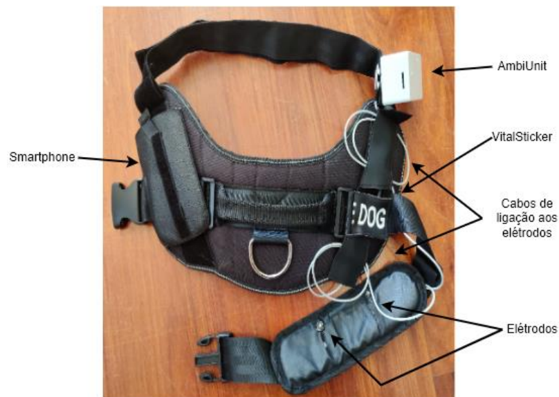
Figura 19 - Localização dos componentes do VitalResponder na adaptação do colete.
