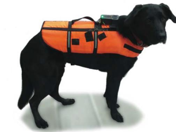
Figura 4 - A unidade de recepção (preta com LED verde) recebe comandos do transmissor e ativa os motores de vibração embebidos no colete [24]
