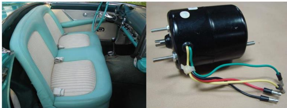
Figura 4 - Motor elétrico de 12V para banco de potência do primeiro modelo do Ford Thunderbird [7]
