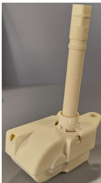
Figura 59 - Protótipo do sistema de regulação lombar montado
