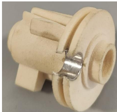
Figura 61 - Roda helicoidal com casquilho de ajuste
