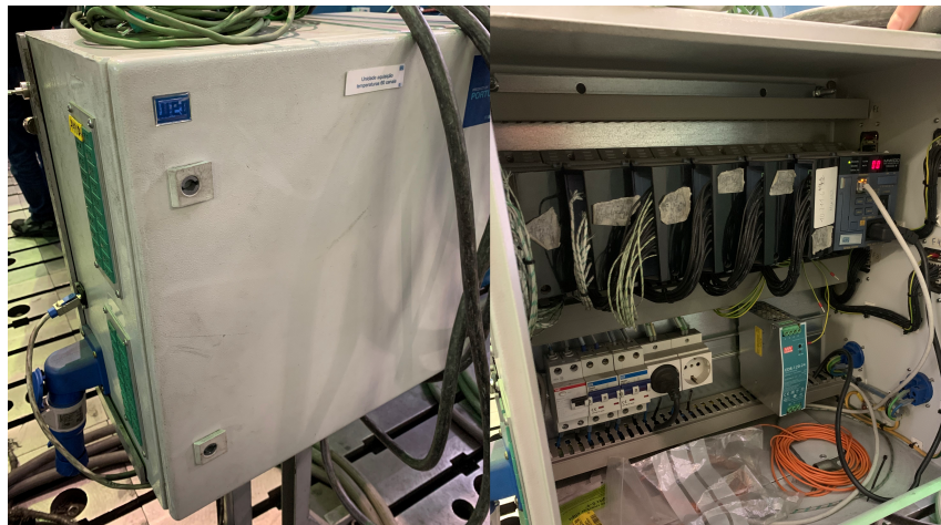
Figura 4.7: Unidade de aquisição de temperatura de 60 canais
