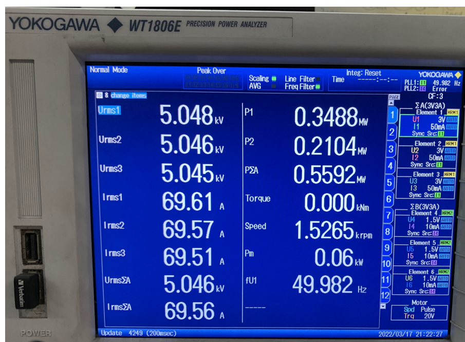
Figura B.5: Valores adquiridos ensaio DOL Entrada e Saída MVW3000
