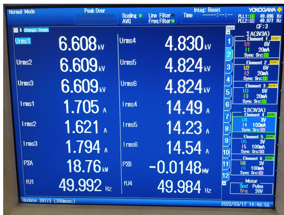
Figura B.1: Valores adquiridos ensaio vazio Entrada e Saída MVW3000
