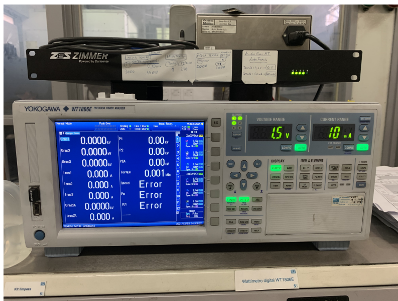
Figura 4.5: ZIMMER PCTSIU-4-1U e Wattímetro Digital YOKOGAWA WT1806E respectivamente
