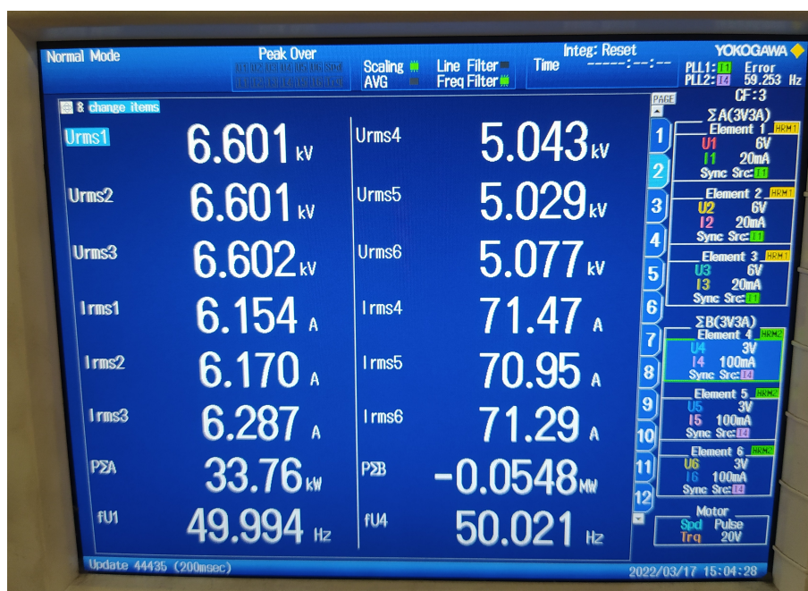
Figura B.3: Valores adquiridos ensaio DF (60 Hz) Entrada e Saída MVW3000
