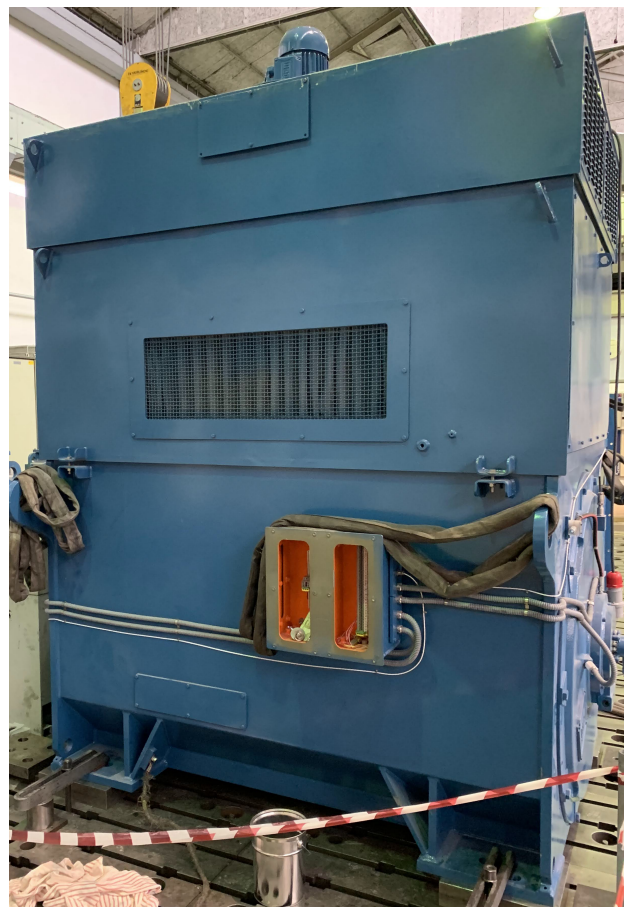
Figura 4.15: Motor de indução trifásico WEG W60 630 L 4
