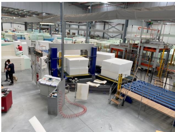
Figura 19 - Corte horizontal de blocos em coxins (Carrossel)
