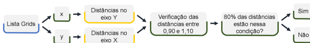
Figura 6.41 – Lógica para o critério Modularização Paredes.
