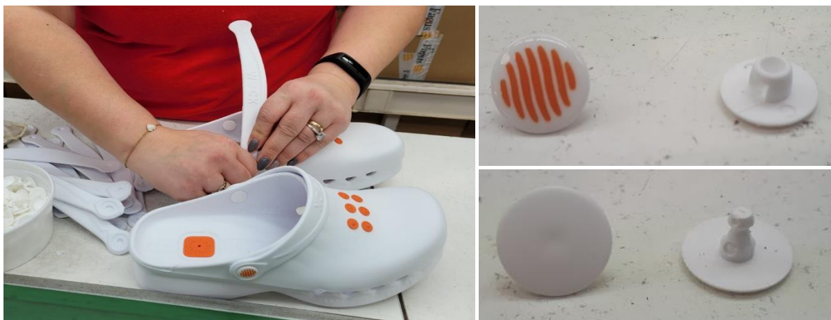
Figura 14- Método manual de inserção da tira (lado esquerdo) utilizando-se fixadores (lado direito).
