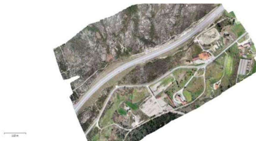
Figura 8 – Exemplo de um ortomosaico (correspondente à área da Figura 6)
