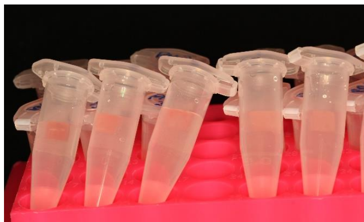
Figura 15. Espécimes imersos em PBS para serem levados ao ultrassom.
