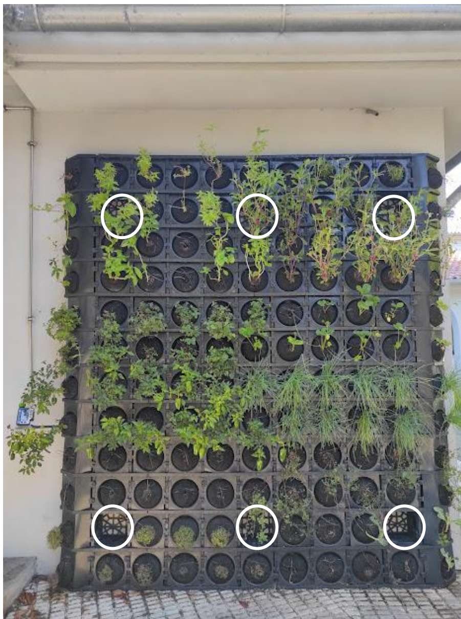
Figura 42 - Pontos da parede onde foram realizadas as medições do volume de água fornecido pelos gotejadores durante 1 minuto
