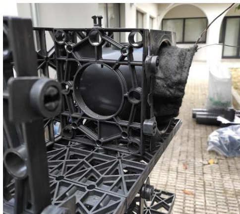
Figura 28 - Exemplo de um saco colocado num módulo já encaixado na estrutura
