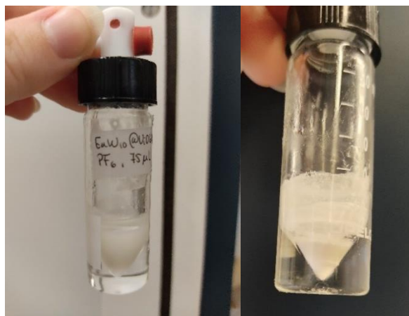
Figura 2.24. Imagem do reator após o terceiro ciclo de reutilização, usando-se o catalisador \text{EuW}_{10}@\text{UiO}-66-\text{NH}_2 (com 3 \mu\text{mol} de centro ativo) nas condições experimentais: 750 \mu\text{L} de [\text{BMIM}]\text{PF}_6 , 75 \mu\text{L} de \text{H}_2\text{O}_2 a 70 ^\circ\text{C} .
