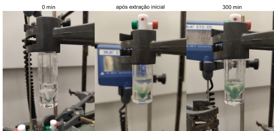
Figura 4.17. Representação do processo de dessulfurização em diferentes momentos do processo, com o catalisador \text{PMo}_{12} @MIL-101@SBA-15 contendo 1,5 \mu\text{mol} de centro ativo \text{PMo}_{12} , 750 \mu\text{L} de MeOH, 750 \mu\text{L} de OM e 75 \mu\text{L} de \text{H}_2\text{O}_2 .
