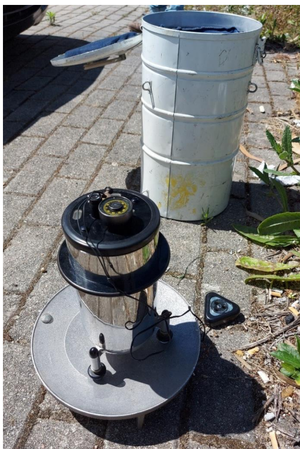
Figura 27 - Gravímetro the Pioneer, Worden n°679, model 155, posicionado em cima do prato côncavo e a respetiva caixa de transporte.
