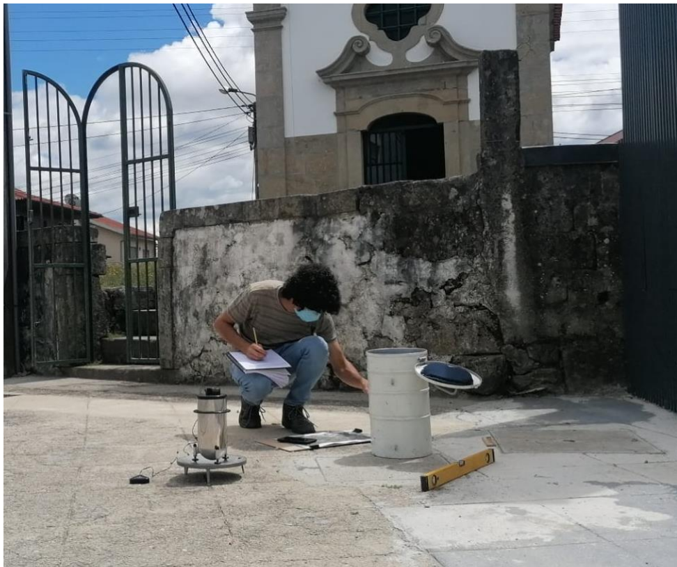
Figura 36 - Gravímetro the Pioneer, Worden nº679, model 155 e o seu respetivo utilizador.
