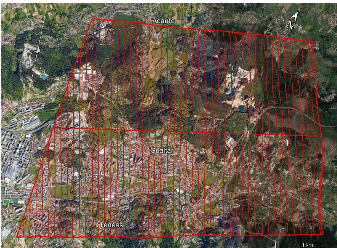
Figura 33 - Representação do eixo e das suas retas perpendiculares, espaçadas com 100 metros, na área da campanha gravimétrica (fotografia de satélite extraída do Google Earth , 2021).
