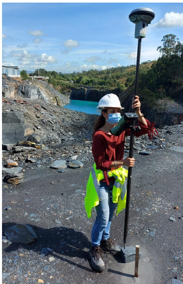
Figura 10 - Obtenção das coordenadas das estacas, com recurso a GPS diferencial.
