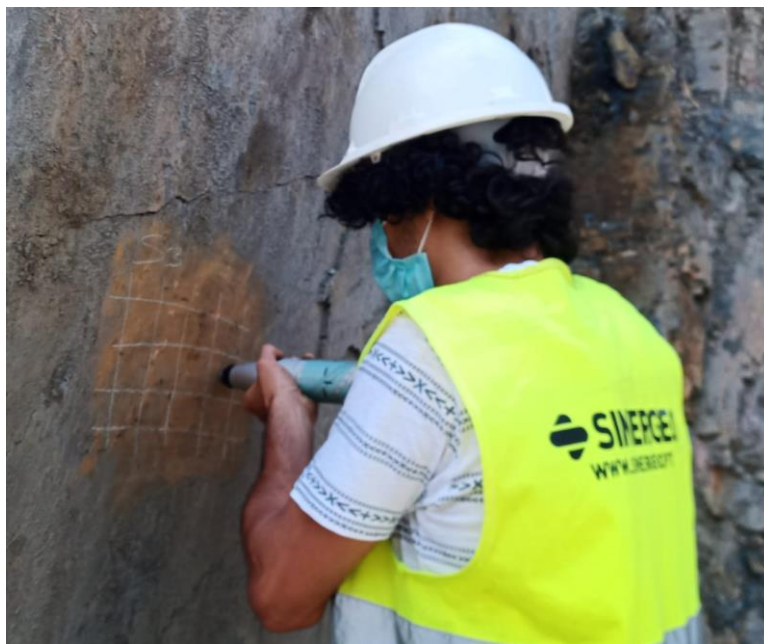
Figura 14 - Uso do esclerômetro de Schmidt, numa rede de ensaios.
