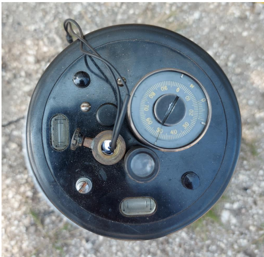
Figura 37 - Topo do gravímetro, com os dois níveis de bolha horizontais, a luz, o óculo e o parafuso de medição.
