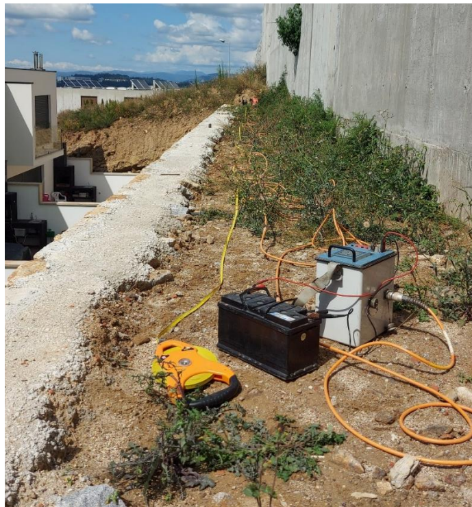
Figura 8 - Sondagem elétrica vertical no aterro inferior.
