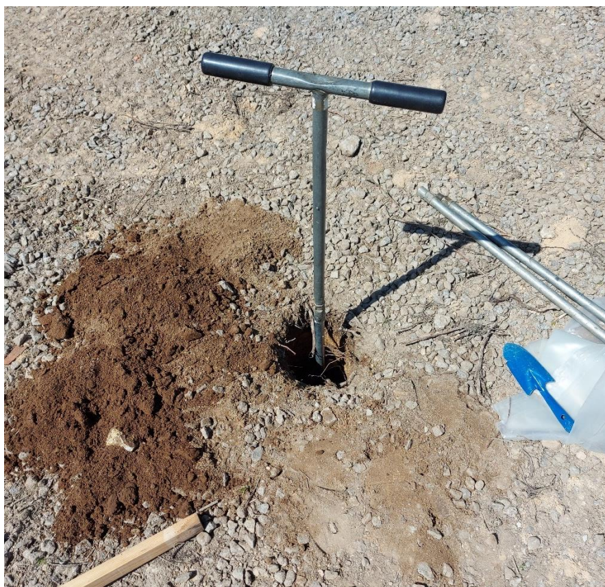
Figura 6 - Sondagem com trado manual, para recolha de solo.
