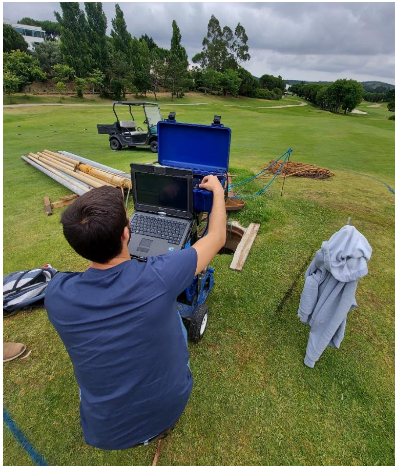
Figura 17 - Manuseamento e visualização em tempo real da filmagem do furo de captação de água com RCAM 1000 da Laval underground Surveys.
