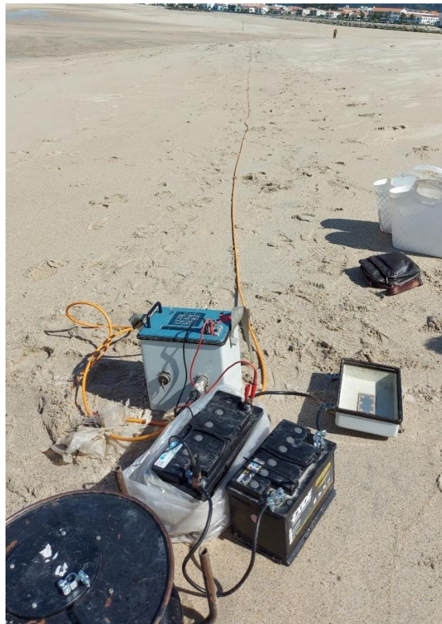
Figura 3 - Oitava sondagem elétrica vertical, onde é possível observar o cabo elétrico, os elétrodos, o resistímetro e as baterias.
