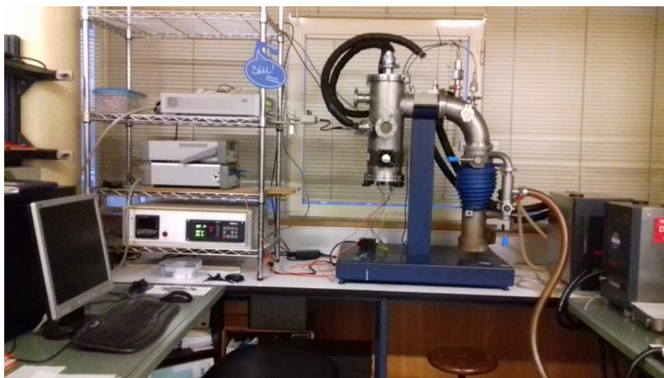
Fig.2.23 – Camara de operação do “KEMQM” e interface de utilizador.
