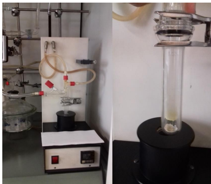
Fig.2.2 – À esquerda a montagem do sistema de purificação por sublimação. À direita, imagem ampliada do coldfinger onde ocorre a cristalização.
