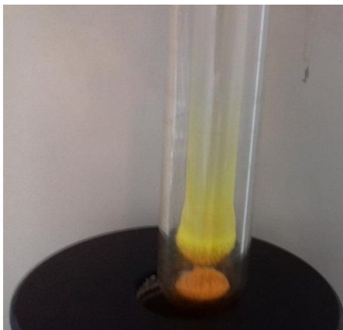
Fig.2.26 – Polimorfismo colorido verificado durante a purificação do 2,7-Difenilfluoren-9-ona.
