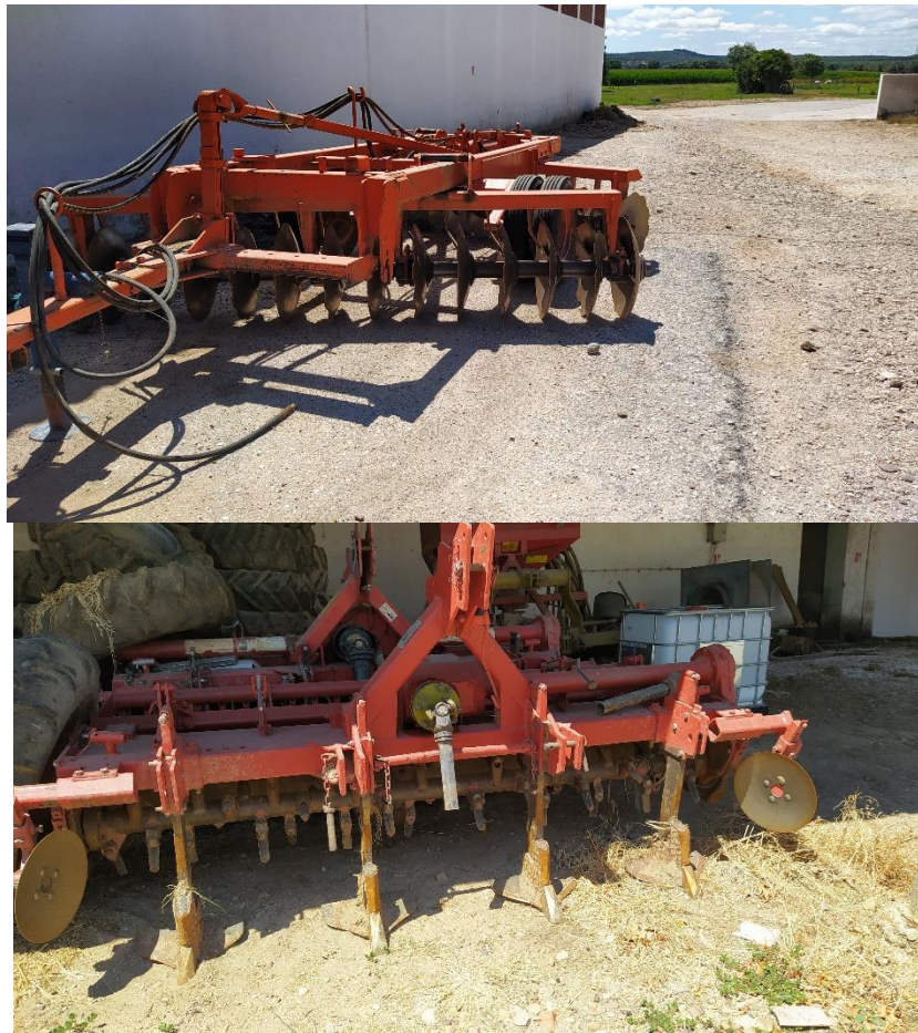
Figura 9- Grade de discos de fresa de eixo horizontal utilizadas na preparação do solo para a instalação da cultura do milho.
