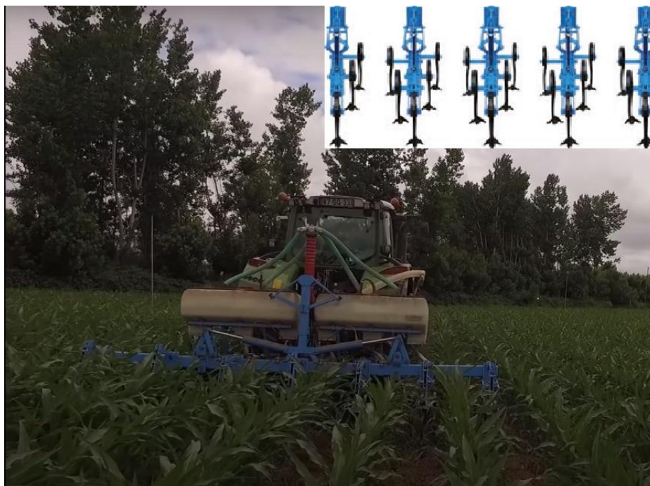
Figura 11- Sachador com dentes em S usado no ensaio. Este equipamento está também equipado com tremonha para fazer a aplicação de fertilizantes.
