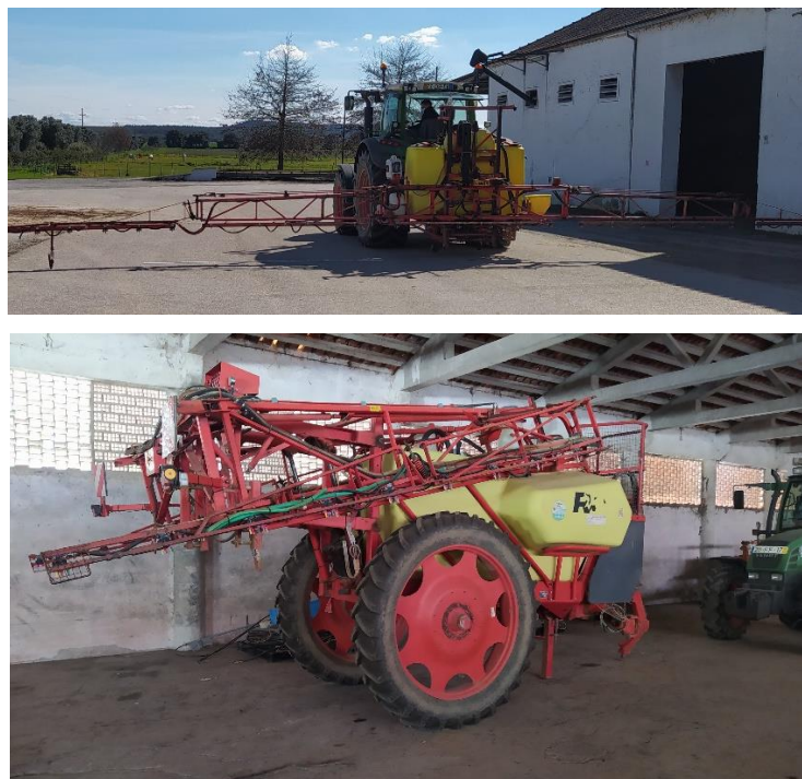
Figura 10- Pulverizadores de jato projetado (montado e rebocado) utilizados no ensaio.
