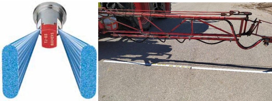
Figura 16- Bicos Teejet TJ60-4004EVS e montagem na seção da barra do pulverizador utilizada na aplicação localizada de herbicida (Tratamento 2).
