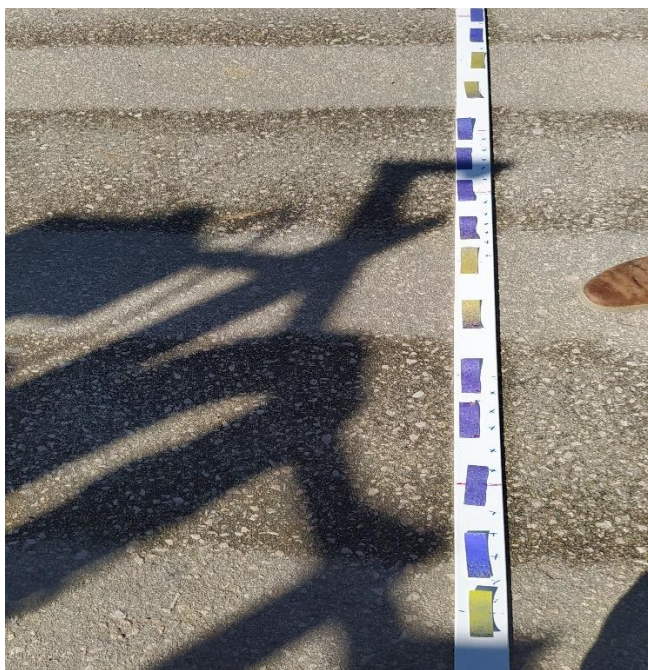
Figura 18- Calha com “papéis hidrossensíveis” colocada perpendicular à rota do trator no local de passagem dos bicos para análise da precisão do sistema RTK-GPS
