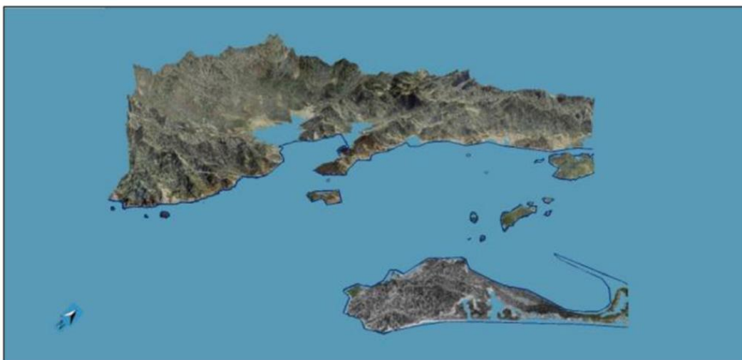
Fig. 17: Áreas costeiras do município de Mangaratiba atualizadas pela elevação do nível do mar de 2,15m.
