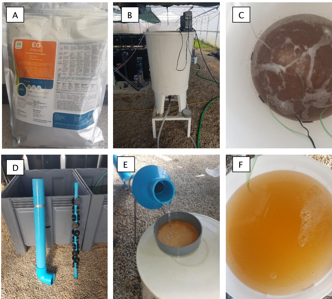
Figura 24 – A – Pacote comercial de Cistos de artémia; B – Tanque para eclosão de artémia; C – Cistos de artémia durante o procedimento; D – Sep-Art Artemia Cysts ; E – Saída dos náuplios de artémia do Sep- Art com natação livre; F – Aparência final dos náuplios.
