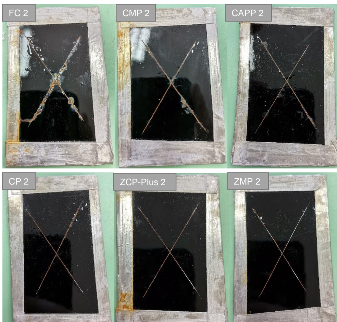
Figura 68: Resultado das chapas D ao fim de 270 horas na câmara de nevoeiro salino.
