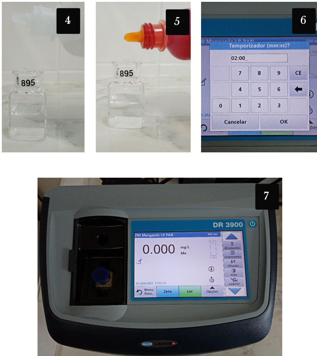
Figura 42 Procedimento para a análise da água tratada quanto à presença de Manganês. 1.1 – Célula quadrada com 10 ml de água destilada; 1.2 – Adição de ácido ascórbico à água destilada; 1.3 – Adição de cianeto alcalino à água destilada; 1.4 – Adição do reagente PAN à água destilada; 1.5 – Tempo de reação de 2 minutos; 1.6 – Obter o valor zero; 2 – Célula quadrada com 10 ml da amostra; 3 – Adição de ácido ascórbico à amostra; 4 – Adição de cianeto alcalino à amostra; 5 – Adição do reagente PAN à amostra; 6 – Tempo de reação de 2 minutos; 7 – Fazer a leitura da amostra em mg/L. Fotografias de Ana Raquel Magalhães.
