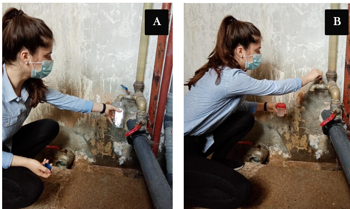
Figura 15 Recolha de amostras. A – Recolha de amostra para análises físico-químicas; B – Recolha de amostra para análises microbiológicas. Fotografias de Joaquim Pinheiro.
