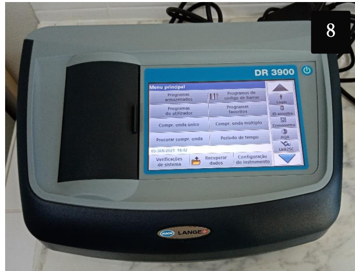
Figura 43 Equipamentos utilizados para as várias análises descritas ao longo deste relatório. 1 – Turbidímetro (HACH 2100Q PORTABLE); 2 – Medidor de pH (HACH HQ11D); 3 – Colorímetro (HACH POCKET COLOR); 4 – Condutivímetro (HACH HQ14D); 5 – Seladora (IDEXX Quanti-Tray Sealer Model 2X); 6 – Incubadora (RAYPA I-20); 7 – Cabine de Análises de Florescência (Spectroline CM-10A); 8 – Espectrofotômetro (HACH DR 3900). Fotografias de Ana Raquel Magalhães.
