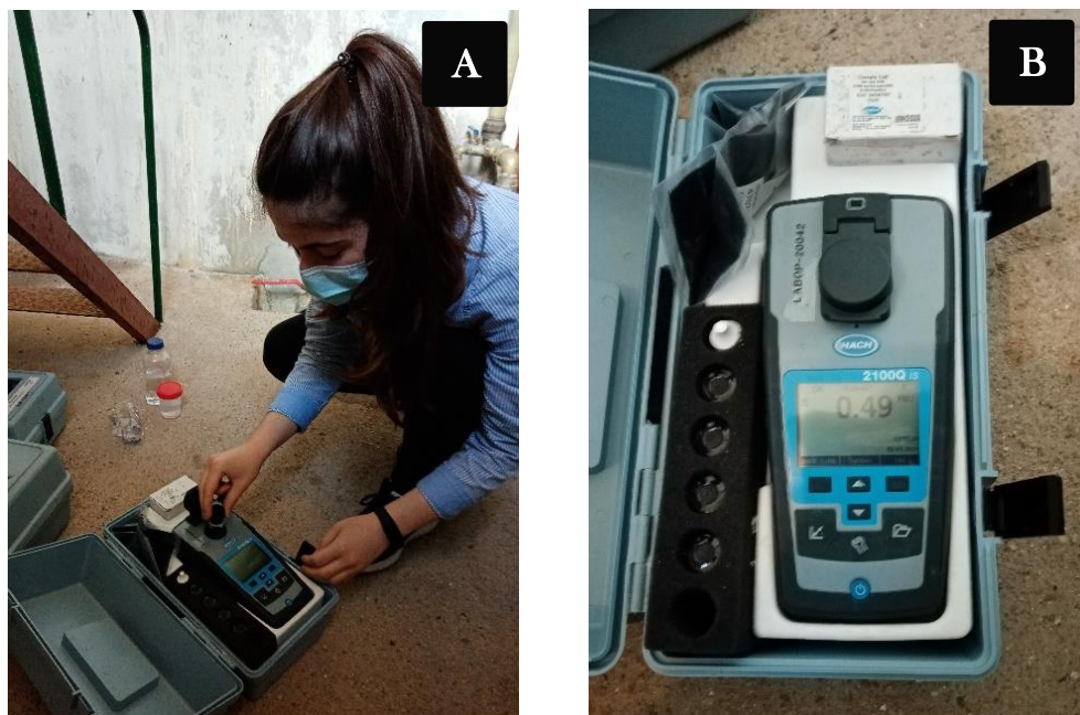
Figura 12 Análise da turvação da água no local da recolha. A – Colocação da célula no turbidímetro; B – Leitura do resultado (0,49 NTU). Fotografias de Joaquim Pinheiro.
