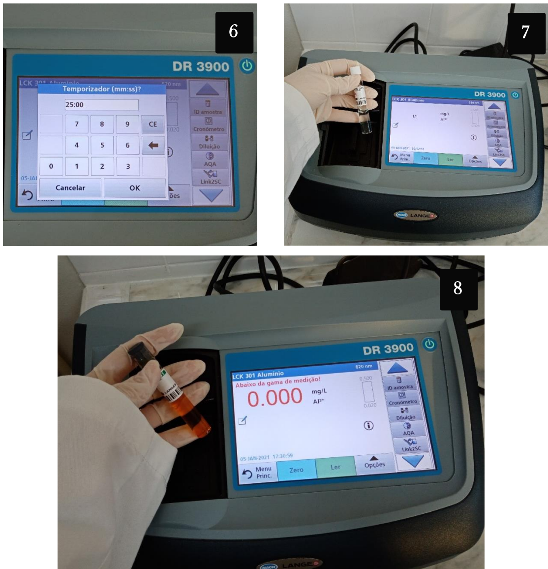
Figura 39 Procedimento para a análise da água tratada quanto à presença de Alumínio. 1 – Amostra da água; 2.1 – Adição de ácido nítrico 65% para ajustar o pH entre 2,5 e 3,5; 2.2 – Leitura do pH da amostra após o ajuste para verificar se este se encontra dentro do intervalo anterior; 3 – Adição de 2 ml de LCK 301 A ao frasco LCK; 4 – Adição de 3 ml ao frasco anterior; 5 – Adição de uma colher de LCK 301 B; 6 – Tempo de reação de 25 minutos; 7 – Obtenção do zero; 8 – Leitura do resultado em mg/L (0mg/L). Fotografias de Ana Raquel Magalhães.
