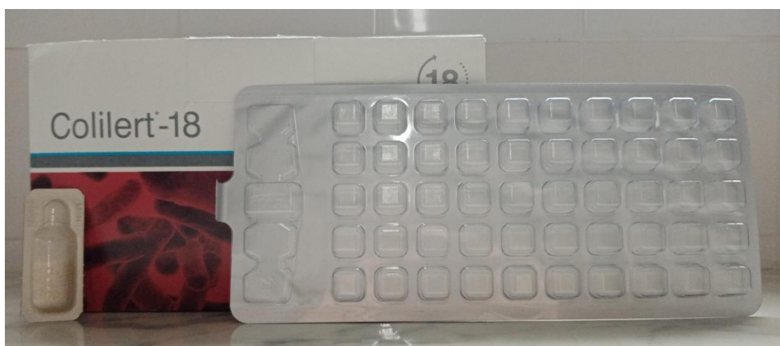
Figura 11 Kit da IDEXX Laboratories para a deteção de coliformes totais e da Escherichia coli , juntamente, com o reagente utilizado o ortonitrofenil- \beta -D-galactopiranosídeo (ONPG) em conjunto com o 4-metilumbeliferil- \beta -D-glucuronídeo (MUG)) e a Quanti-Tray com os 51 poços discretos. Fotografia de Ana Raquel Magalhães.
