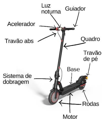
Figura 7. Partes gerais da trotinete elétrica
