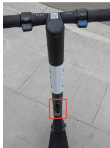
Figura 60. Entrada de carregador no tubo vertical
