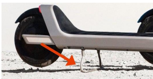
Figura 32. Detalhe do apoio da Bird Two
