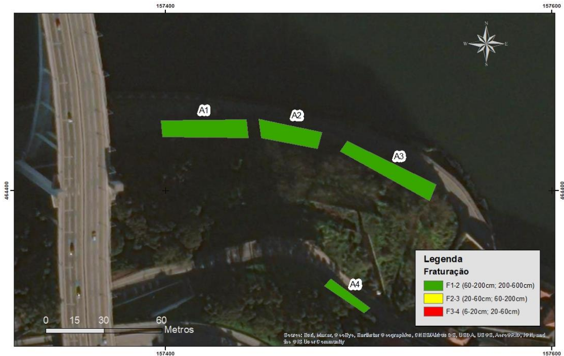
Figura 94 - Carta de Fraturação para as Áreas de Porto e Serra do pilar (em cima) e Área da Arrábida (em baixo).
