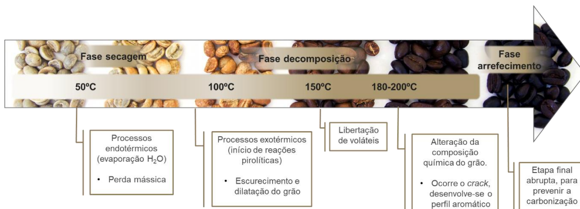
Figura 4 - Representação esquemática dos traços gerais da progressão de uma torra (adaptado de Louzada Pereira [17] e Belitz [18] ).
