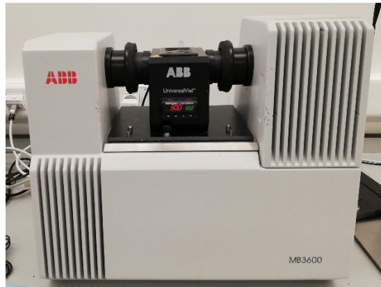
Figura 34- Espectrofotómetro NIR equipado com acessório para vials .
