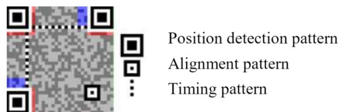
Figura 6 – Elementos que compõem um código QR. Adaptado de: [109].
