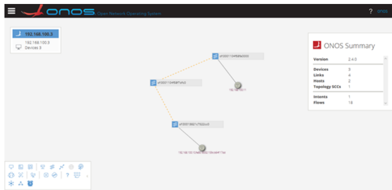
Figura 3.4: Falha na ligação entre comutadores
