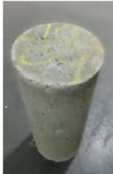
Figura 9: Corpo de prova de concreto com cimento fabricado em 2020.
