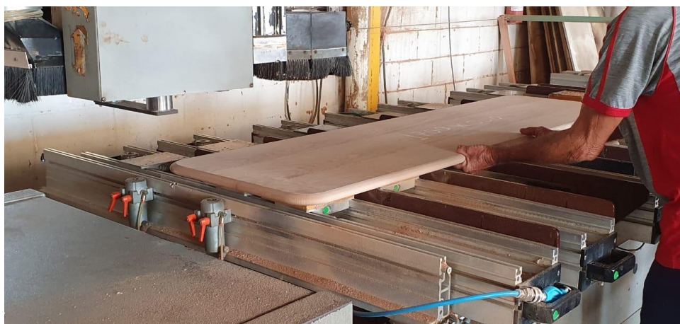
Figura 56: Confecção do tampo da mesa de centro Soft em CNC (Baldissera 2021).
