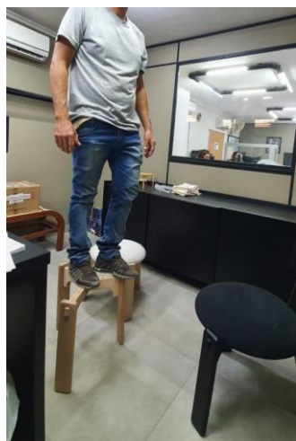
Figura 85 e 86: travamentos apresentam excelente resistência e estabilidade, por conta da perna traseira com inclinação (Baldiissera 2021).
