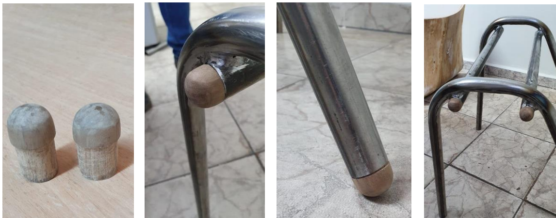
Figuras 119, 120, 121, 122: sequência de imagens das ponteiros de madeira produzidas a partir de retalhos de madeira. Serão utilizados em todos os produtos da linha Joy.
