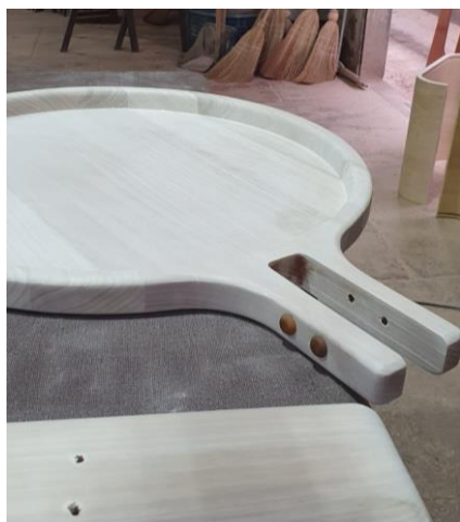
Figura 99: Bandeja executada em CNC, com retalhos de madeira (Baldiisera 2021)
