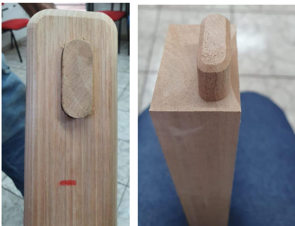
Figura 70: Espiga antes do padrão chanfrado e depois do chanfro, padrão para toda a linha (Baldissera 2021).
