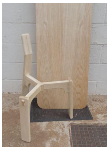
Figura 85 e 86: travamentos apresentam excelente resistência e estabilidade, por conta da perna traseira com inclinação (Baldiissera 2021).
