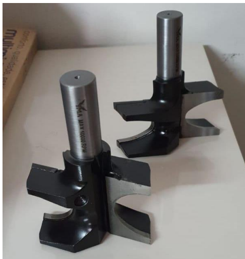
Figura 68: Fresa de acabamento de borda do tampo, desenvolvida especialmente para a linha Soft (Baldiçera 2021)
