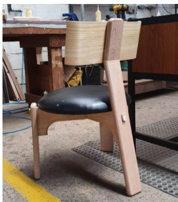
Figura 83: Teste com perna traseira inclinada melhora estabilidade (Baldiissera 2021).
