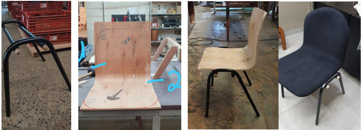
Figuras 123, 124, 125 e 126: Sequencia de imagens do 1º protótipo, recusado não seguir os raios originais das curvas da estrutura. A concha é meramente ilustrativa, uma vez que foi desenvolvida uma concha exclusiva para esta cadeira com um fornecedor terceiro
