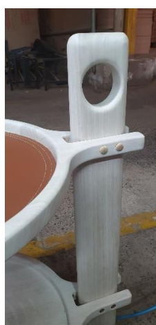
Figura 101: Detalhe da alça, e dos tapa-furos (Baldiisera 2021)
