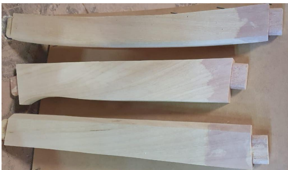
Figura 65: Testes do acabamento Ash (clareado) na madeira Jequitibá (Baldiçsera 2021).
