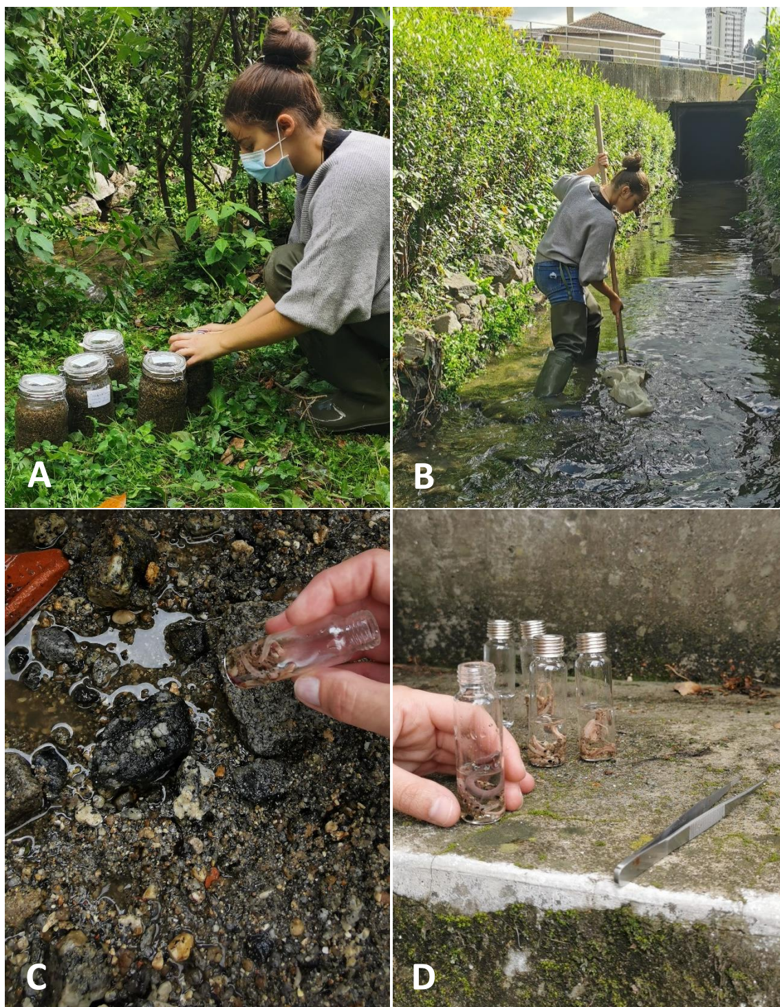
Figura 28: Saídas de campo para recolha de amostra de sedimento (A) e de amostras biológicas através da recolha de macroinvertebrados bentónicos (B), separação dos organismos de classe Oligochaeta (C) e o seu armazenamento em frascos de vidro com etanol 70% (D).
