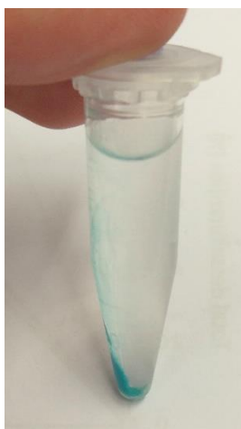
Figura 5.8. Alíquota resultante da adsorção de MB pelo PMOB-TMAPS ao fim de 240 minutos.
