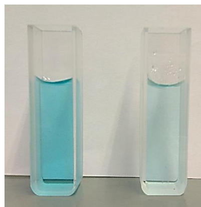
Figura 5.3. Alteração da cor da solução corante de MB após aplicação das LPMS.
