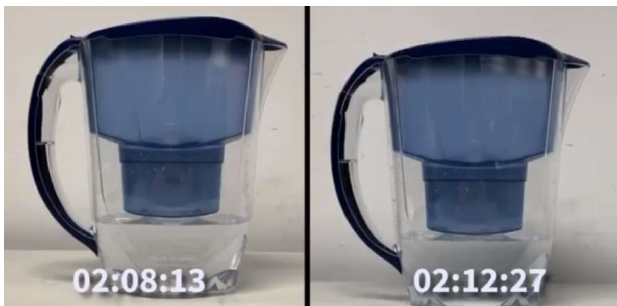
Figura 40: Ensaio do funil sem furo extra e com 2 furos extras. Fonte: Imagem cedida pela equipa 6
