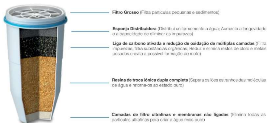
Figura 23: Vista de corte esquemática do filtro da marca Zerowater. Fonte: Imagem cedida pela equipa 5
