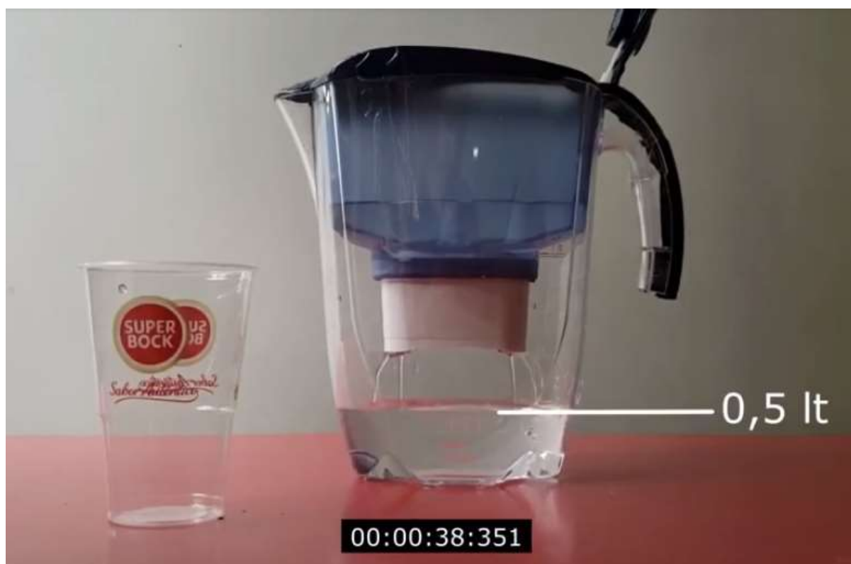
Figura 41: Teste sem o envólucro do filtro e com a pega cortada. Fonte: Imagem cedida pela equipa 6
