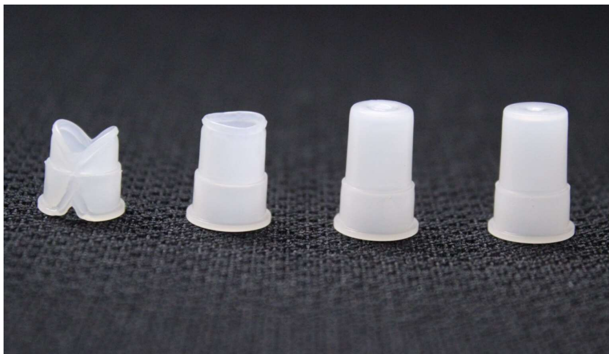
Figura 138: Peças com injeção incompleta. Fonte: ( https://fit-tecnologia.com.br/injecao-de-plasticos-7-problemas-que-podem-atrapalhar-sua-producao/ )
