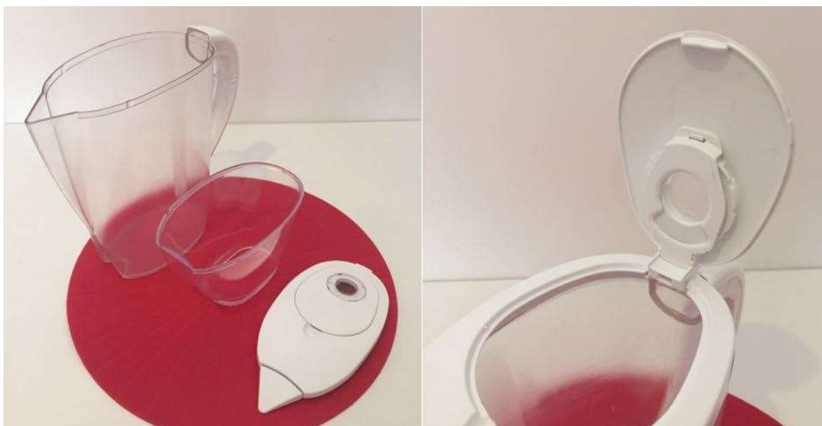
Figura 140: Ensaio de injeção do conjunto completo 2. Fonte: Acervo do autor
