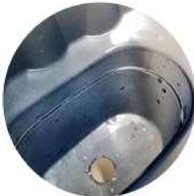
Figura 39: Furo de saída de água aumentado. Fonte: Imagem cedida pela equipa 4
