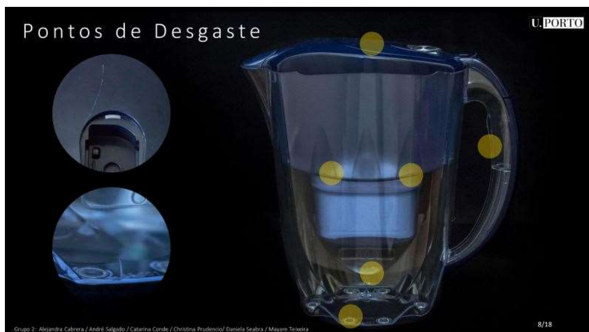
Figura 53: Locais de maior desgaste mostram que a maioria é devido à sua largura. Fonte: Imagem cedida pela equipa 2
