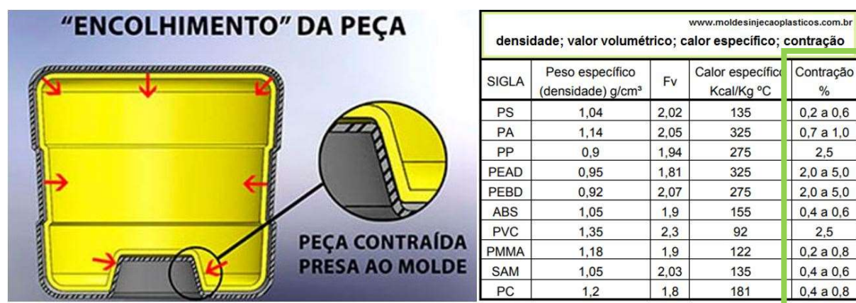
Figura 133: Exemplo de peça presa ao molde pela contração do material. Fonte: ( https://rotodesign.wordpress.com/paradesigners/ ) e tabela de contrações de materiais. Fonte: ( http://moldesinjecaoplasticos.com.br/tabelas-com-valores-para-aplicacoes-de-plasticos/ )
