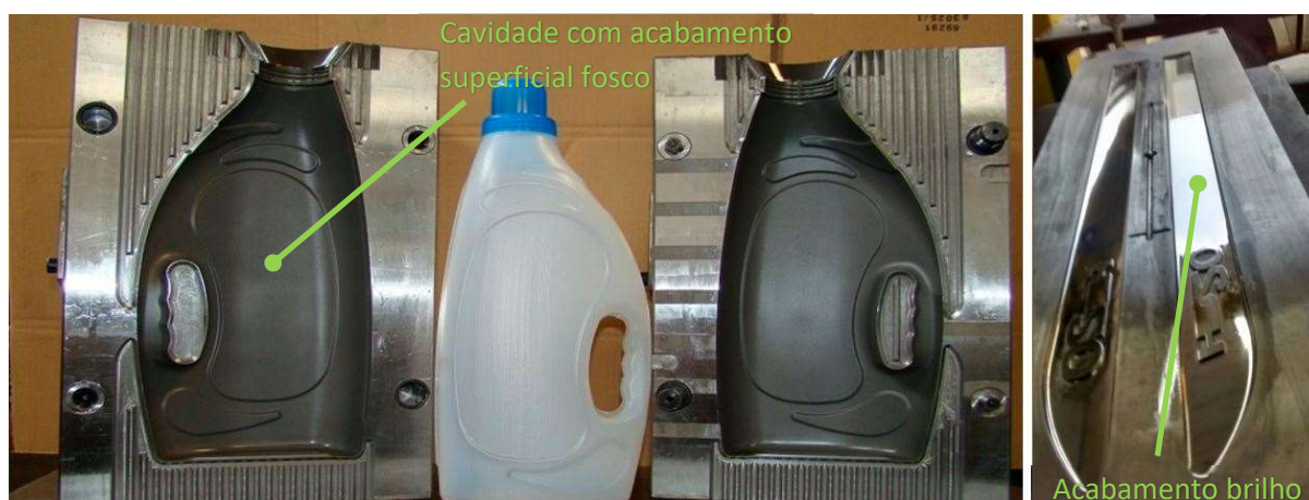
Figura 135: À esquerda uma garrafa opaca e seu molde (Fonte: https://www.injecaoodeplasticos.com.br/quais-os-tipos-de-moldes-para-injec%C3%A7%C3%A3o-de-termoplastico/ ). À direita um molde com acabamento para peça a brilho (Fonte: http://www.sosmoldes.com.br/conteu )
