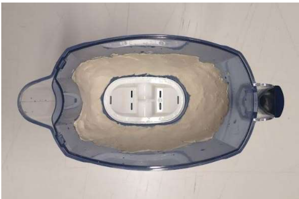
Figura 35: Funil com plasticina aplicada à parede interna do funil. Fonte: Imagem cedida pela equipa 6
