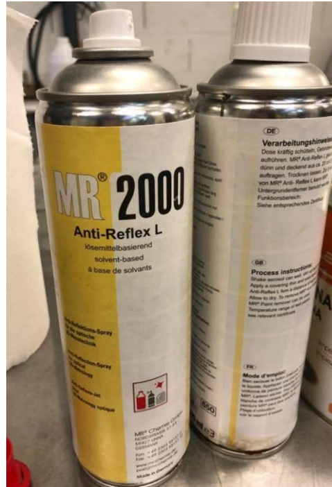
Figura 19. Spray anti-reflexo utilizado para preparação do escaneamento 3D dos provetes (Autor, 2021).
