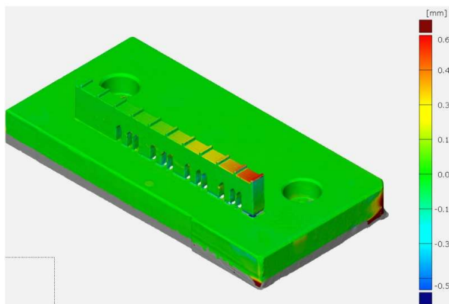
Figura 33. Resultado do escaneamento 3D mostrando a distorção do provete A.
