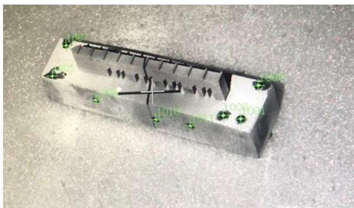
Figura 23. Mapeamento dos pontos para geração da geometria (Autor, 2021).
