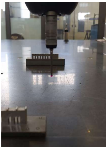
Figura 16. Máquina da Tornitrofa com medição por coordenadas com 3 eixos, para efetuar a medição da altura de cada ressalto (Autor, 2021).
