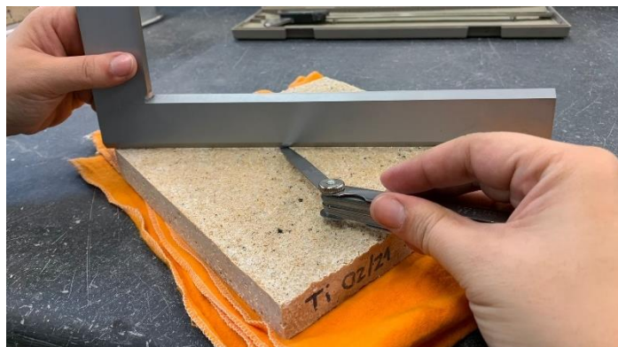
Figura 3.26. Verificação da planeza da superfície.
