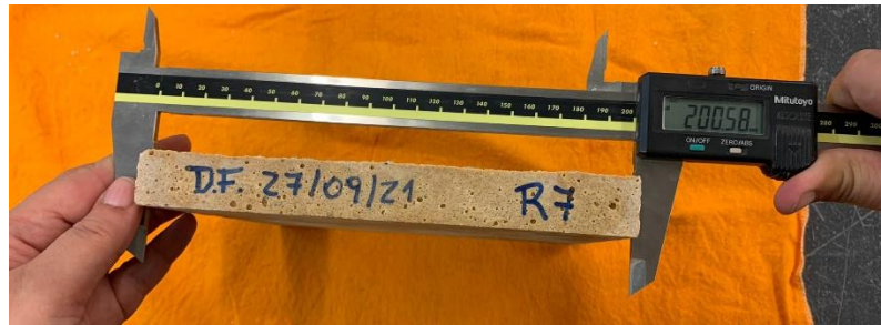
Figura 3.24. Medição com paquímetro.
