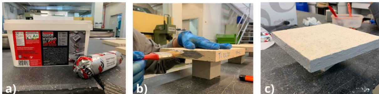
Figura 3.30. Impermeabilização do mosaico. a) Impermeabilizante; b) Aplicação do impermeabilizante; c) Mosaico com as laterais impermeabilizadas.
