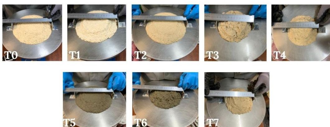
Figura 3. 10. Medição do diâmetro no ensaio de trabalhabilidade.
