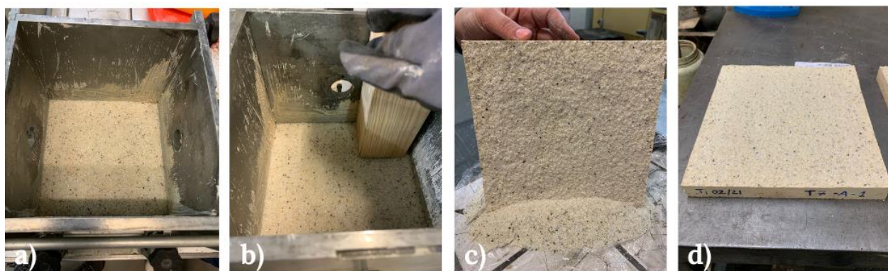
Figura 3.23. Moldagem dos mosaicos com LW polvilhado. a) Mosaico com 127g de LW polvilhado; b) Leve pressão para o LW aderir a argamassa fresca; c) Desmoldagem e retirada do excesso de LW; d) Mosaico identificado.
