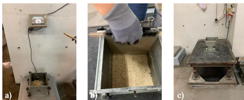
Figura 3.20. Moldagem do ladrilho referência. a) Pesagem da massa; b) Espalhando a argamassa com ferramenta rudimentar; c) Mesa de vibração.
