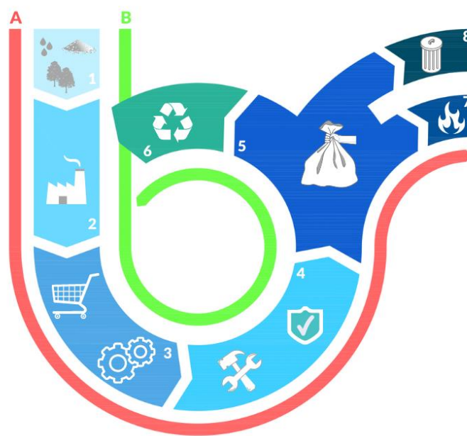
Figura 2.1. Modelo linear (A) versus modelo circular (B): 1) Matéria-prima virgem; 2) Produção e transformação; 3) Consumo e utilização; 4) Manutenção e reutilização; 5) Final da vida útil; 6) Reciclagem; 7) Incineração com valorização energética e 8) Descarte em aterro sanitário
