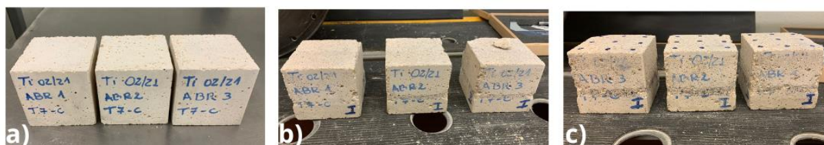
Figura 4.3. Provetes ensaiados. a) Antes do ensaio; b) Após o 8º ciclo; c) Após o 16º ciclo.
