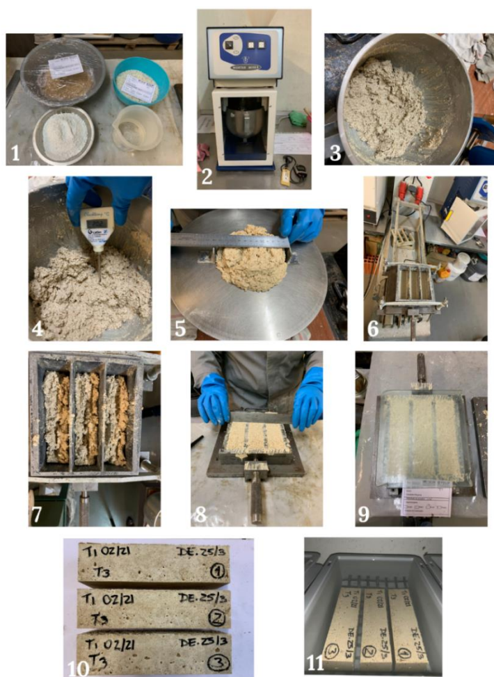
Figura 3.11. Processo de fabricação dos provetes testes. 1) Determinação das quantidades da mistura. 2) Misturador. 3) Mistura pronta. 4) Medição da temperatura da mistura. 5) Medição do diâmetro no ensaio de trabalhabilidade. 6) Compactador. 7) Colocação do material em 2 etapas. 8) Regularização da argamassa no molde. 9) Moldes preenchidos e prontos para descansar 24h. 10) Desmoldagem. 11) Provetes imersos em água para a realização da cura por 27 dias.
