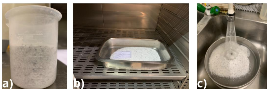
Figura 3.5. Preparo do material. a) Volume do provete; b) Secagem em estufa; c) Lavagem no peneiro 0,0063mm.
