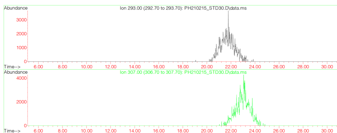
Figura 25: Cromatogramas para os compostos DINP ( m/z : 293) e DIDP ( m/z : 307)
