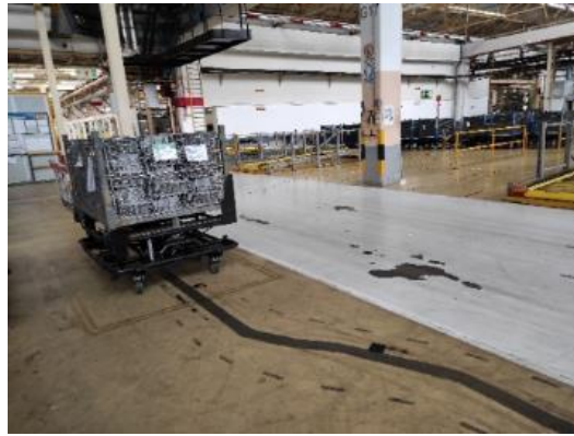
Figura 13 - Carro de stock transportado por um AGV na respetiva pista
