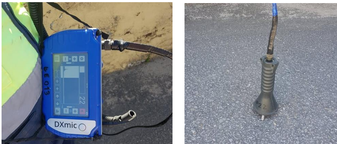
Figura 116 - Equipamento de deteção acústica: sistema de geofone - amplificador (esquerda) e sonda (direita).
