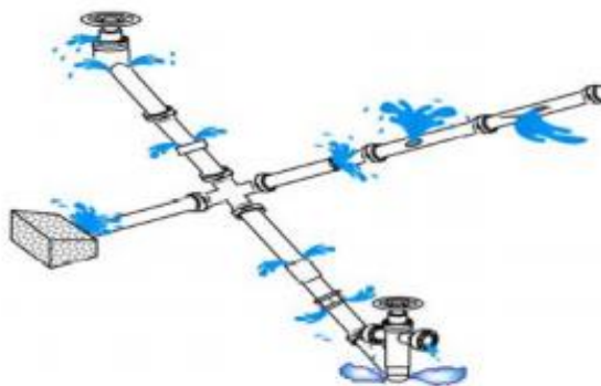
Fig. 31 - Pontos da rede de abastecimento de água onde ocorrem perdas reais frequentes.
