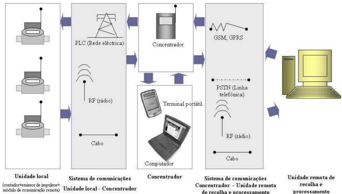
Fig. 112 - Principais componentes de um sistema de telemetria.
