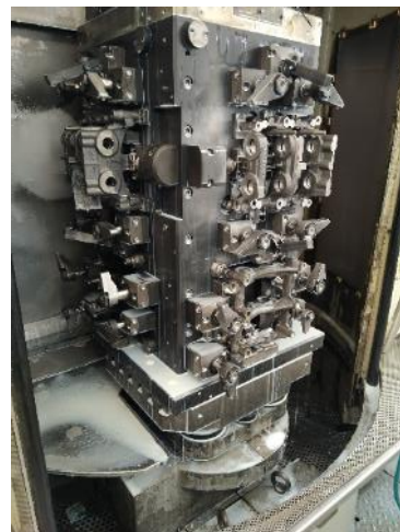
Figura 9 - Peça carregada no centro de maquinação
