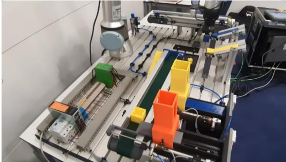
Figura 3.2 - Colocação de uma base cúbica no transportador
