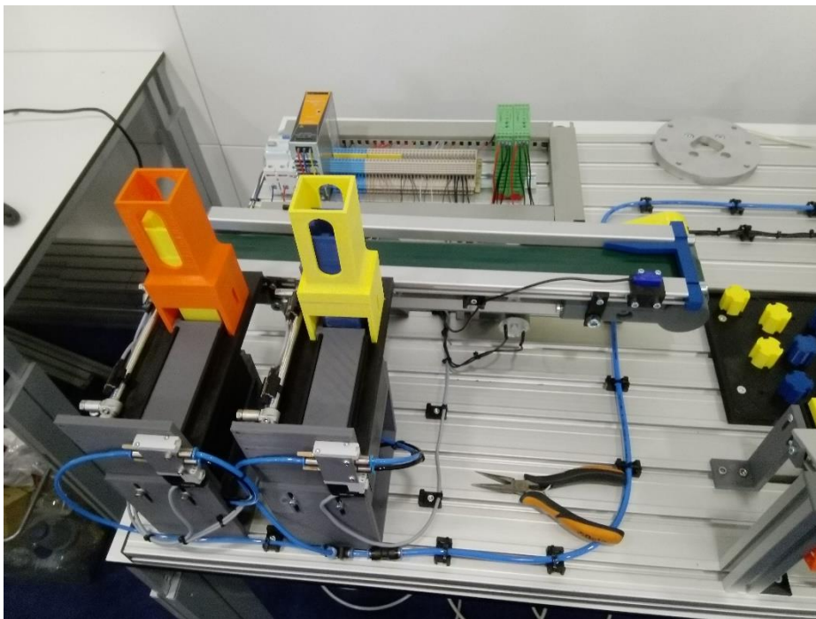
Figura 3.31 - Conveyer inicial e alimentadores
