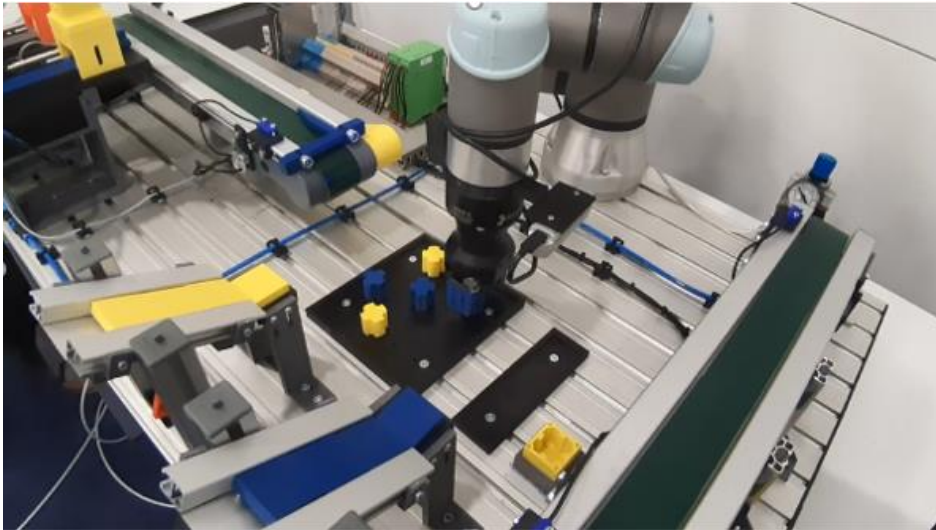
Figura 3.5 - Utilização do sistema de visão para seleção do cilindro
