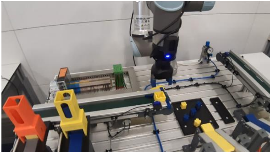
Figura 3.3 - Execução do Conveyor Tracking
