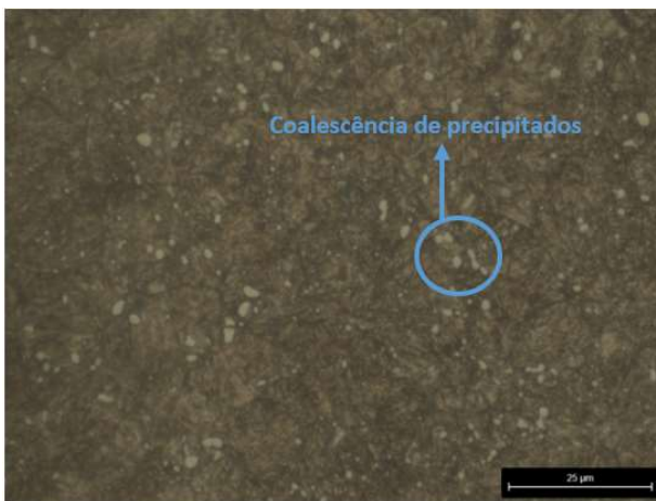
Figura 27 - Microestrutura do aço Tyrax ESR após têmpera a 1050 °C e duplo revenido a 540 °C, constituída por martensite revenida e carbonetos secundários (Amostra 1B). Ataque: Kalling's.
