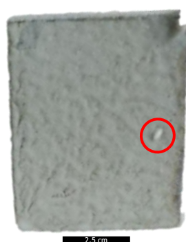
Figura 36 -Novelo de fibras formado na barbotina 3, para uma adição de 0,2% de fibras FFX.
