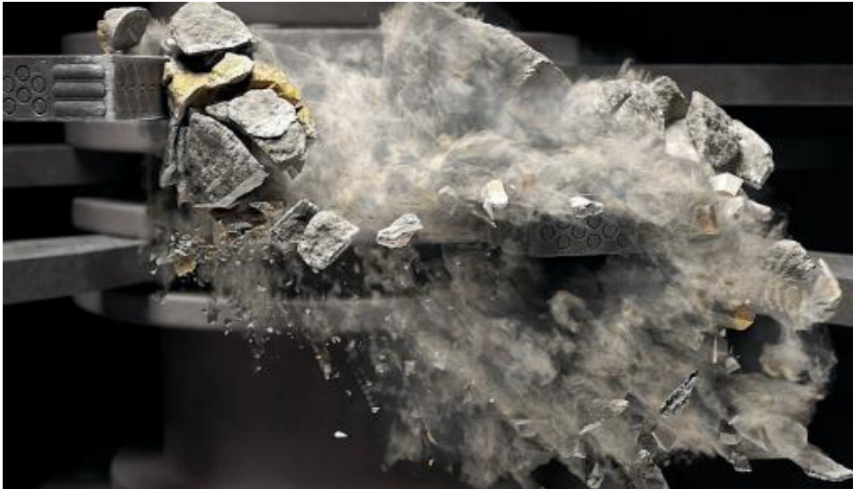
Figura 12- Representação artística da cominuição de impacto de alta velocidade no interior do VEROLIBERATOR® (Borg et al., 2020)
