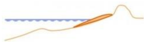
Figura 3.12 - Alimentação artificial emersa na zona balnear da praia (Mangor et al. , 2017 - Adaptado).
