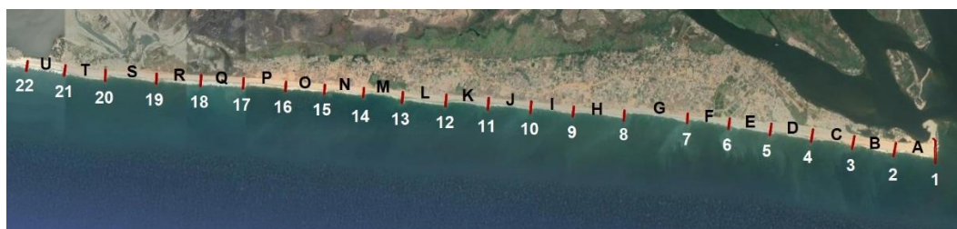
Figura 5.1 - Numeração dos esporões e dos compartimentos criados.
