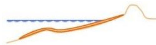
Figura 3.13 - Alimentação artificial do perfil transversal da praia (Mangor et al. , 2017 - Adaptado).
