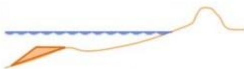
Figura 3.10 - Alimentação artificial imersa na zona de rebentação da praia (Mangor et al. , 2017 - Adaptado).
