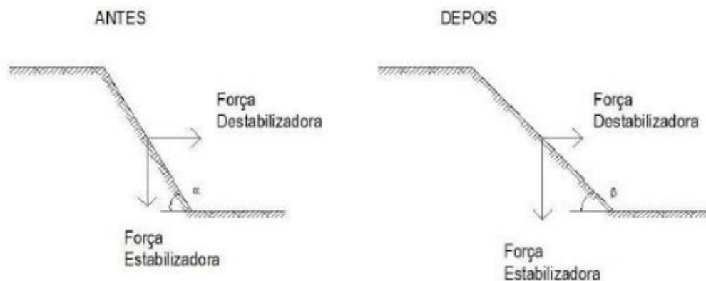
Figura 8.1 – Transformação da geometria de um talude. (Oliveira, 2010)
