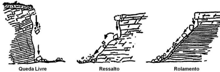
Figura 6.4 – Ilustração das diferentes trajetórias de queda. (Carcedo, 1987)
