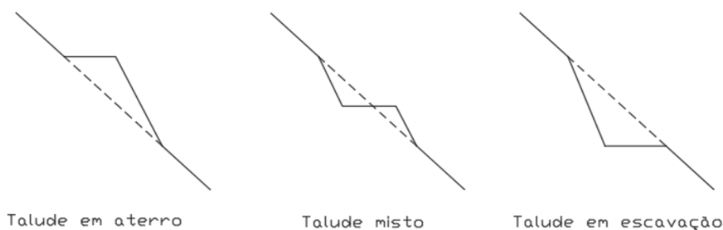
Figura 6.3 – Classificação dos taludes artificiais. (Caputo, 1977)
