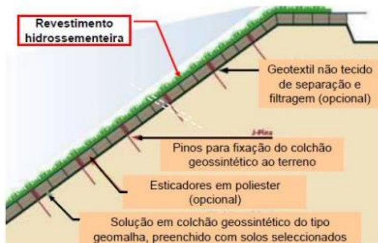
Figura 8.13 – Exemplificação de um recobrimento vegetal por intermédio de geomateriais. (A. Pinto, 2012)
