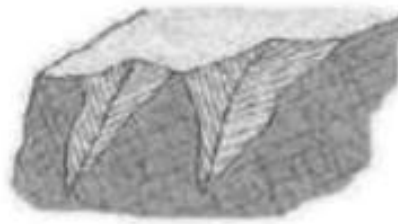
Figura 6.16 – Ilustração de escorregamentos translacionais. (Vallejo et al., 2004)
