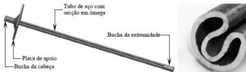
Figura 8.5 – Pregagem de tubo expansivo. (G. Santos, 2014)
