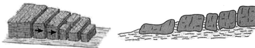
Figura 6.17 – Representação esquemática: expansão lateral. (Vallejo et al., 2004)
