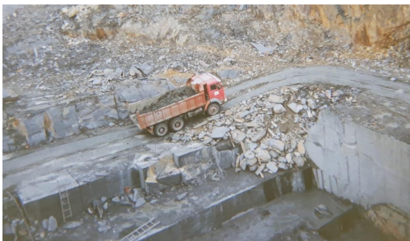
Figura 9.13 – Dumper preenchido por estéril do desmonte dos pilares de ardósia -Área B.
