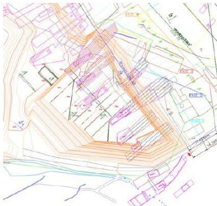
Figura 9.5 – Levantamento topográfico da Pedreira da Milhária. (ELV, 2016)
