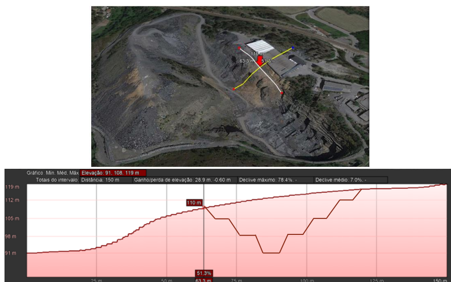
Figura 10.8 – Esquematisação do maciço de contenção e delineação do desmonte. (Adaptado: Google Earth, 2019)
