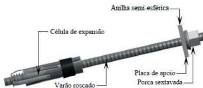
Figura 8.6 – Pregagem de célula expansiva. (G. Santos, 2014)
