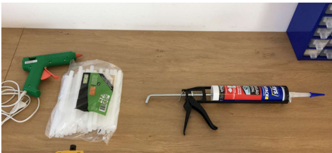
Figura 28 - Substituição da cola quente por uma cola de maior resistência (Figura do autor).
