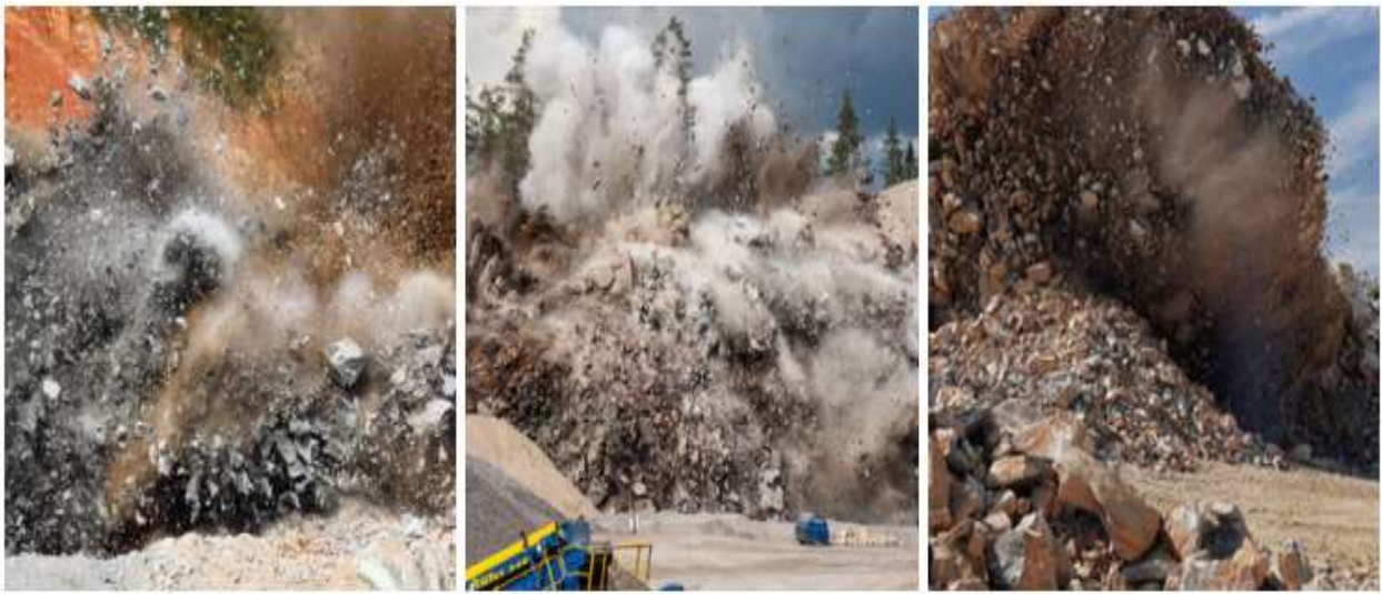
Figura 6 - Lançamento de rochas – Flyrock – na detonação do maciço (Xavier, 2021b).
