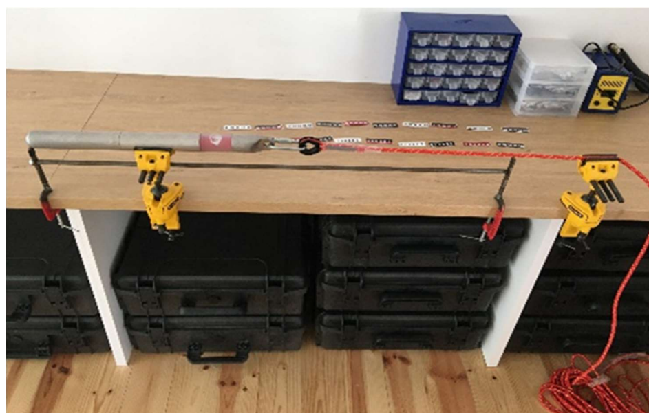
Figura 32 - Marcação do primeiro metro na corda junto com a desviómetro (Figura do Autor).
