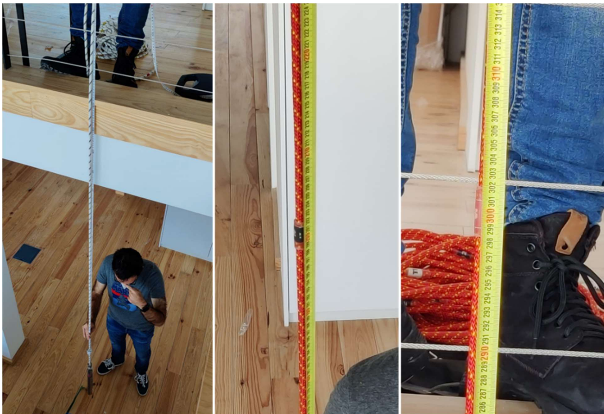
Figura 35 - Verificação da marcação da corda (Figura do Autor).
