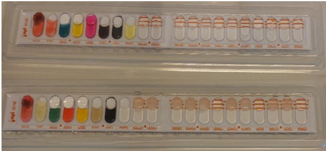
Figura A9. 7. Exemplos de galerias API 20 NE, após incubação.
