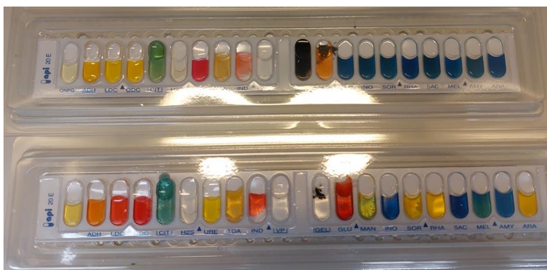
Figura A9. 6. Exemplos de galerias API 20 E, após incubação.
