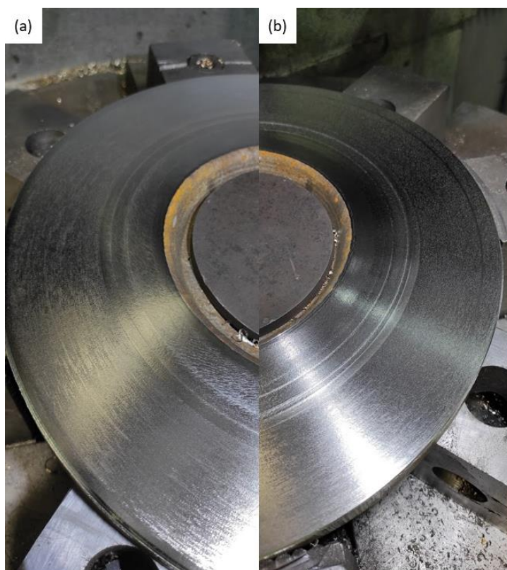
Figura 34 - Superfícies obtida com parâmetros de corte de vc= 50 \text{ m/min} , fn= 0,3 \text{ mm/rot} e ap= 1,2 \text{ mm} , após a remoção da pele de fundição (a); e passagem seguinte (b).
