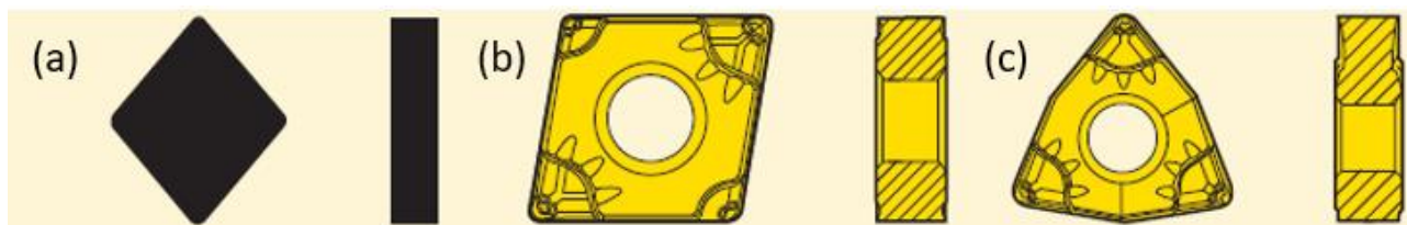
Figura 20 - Representação esquemática das pastilhas de corte utilizadas: CBN600 (a); TH1000 (b) e TH1500 (c). Adaptado de [29].
