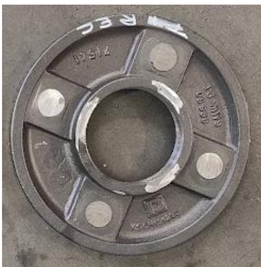
Figura 17 - Fotografia representativa do prato produzido pela CMW a utilizar na realização dos ensaios.
