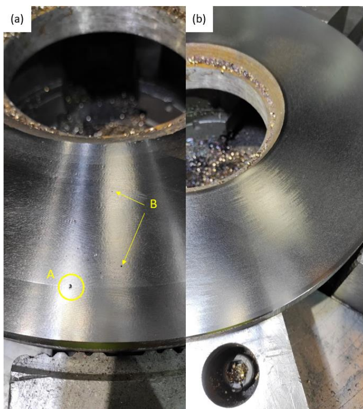
Figura 32 - Superfícies obtidas após realização de ensaios com vc= 50 m/min, fn= 0,2 mm/rot e ap= 0,8 mm (a); vc= 50 m/min, fn= 0,2 mm/rot e ap= 1,2 mm (b). Em A é possível observar uma cratera na superfície maquinada originada por uma incrustação, e em B estão presentes alguns poros.
