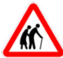
Fig. 22 - Sinalização que alerta para o possível atravessamento de pessoas frágeis ou com deficiência (fonte: Cerema, 2014)
