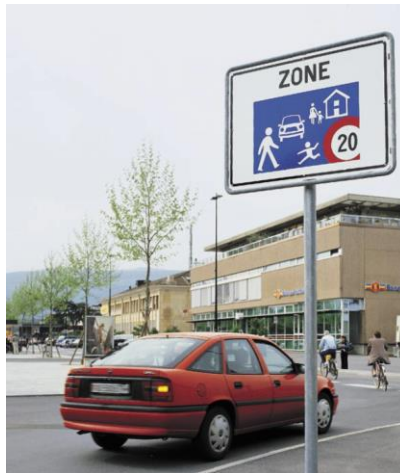
Fig. 32 - Exemplo de prescrição referente ao limite de velocidade numa determinada zona (fonte: OFROU, 2006)
