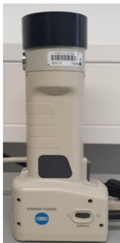
Figura 22. Colorímetro, Konica Minolta, Chroma Meter CR-400 (Japão).
