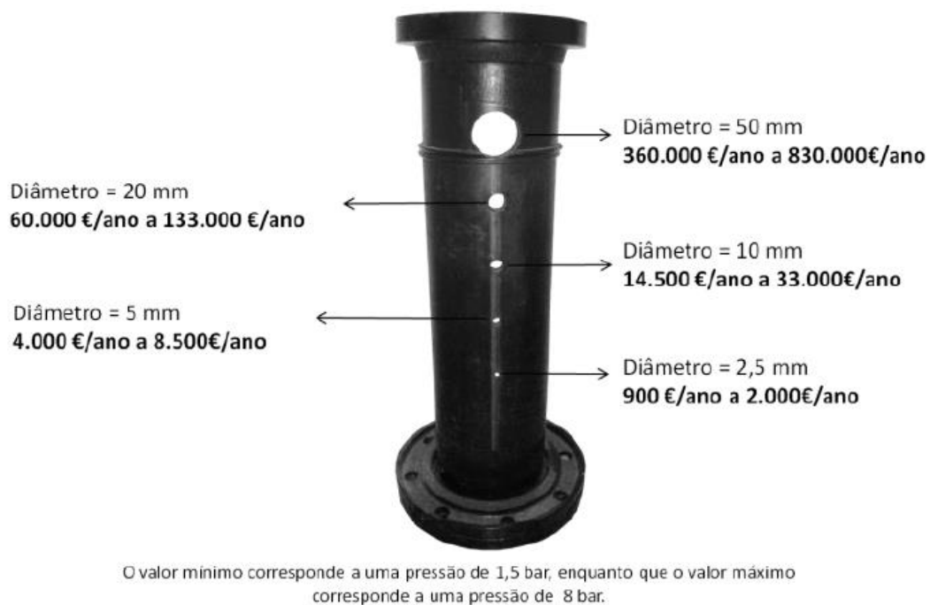
Figura 10 – Relação entre pressão e receita perdida anualmente para diferentes diâmetros. [18]
