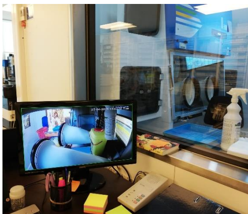
Figura 4: Sistema CCTV para captura de imagem no interior do isolador.
