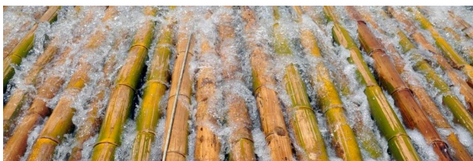
Fig. 4.15 Imersão em água corrente [33]
