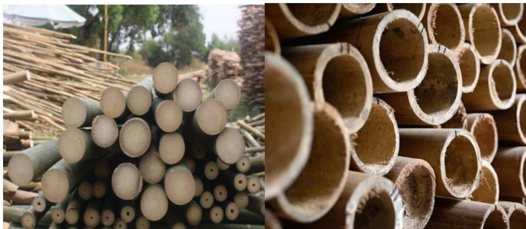
Fig. 3.14 - Bambu sólido ( Thyrsostachys siamensis ) e bambu oco ( Dendrocalamus asper ) [30]
