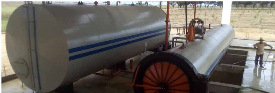
Fig. 4.18 Autoclave para tratamento dos bambus [39]
