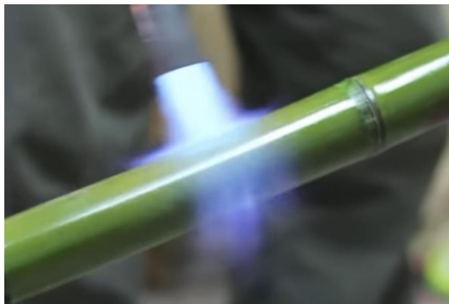
Fig. 4.13 Secagem de bambus com maçarico [37]
