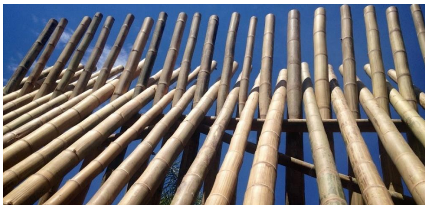
Fig. 4.12 Secagem de bambus ao ar livre [33]
