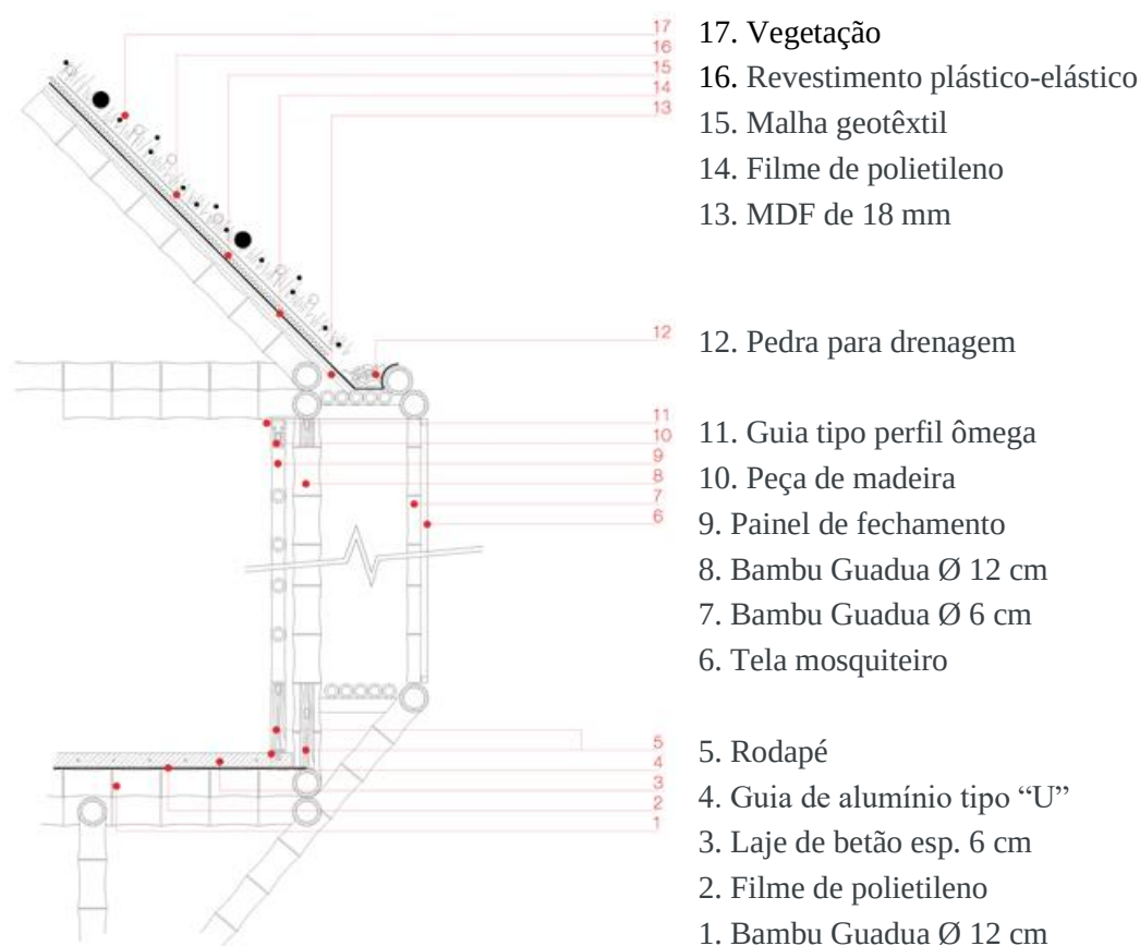
Fig. 7.16 Corte construtivo [55]
