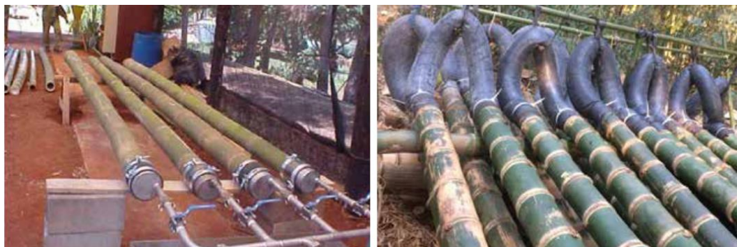
Fig. 4.19 Central de aplicação do tratamento Boucherie [34]
