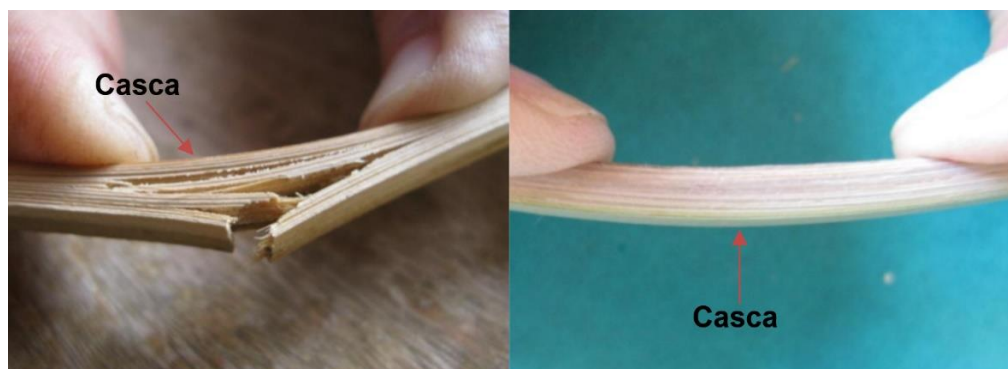
Fig. 3.19 – Flexão de tira do bambu. Com a casca para cima e com a casca para baixo [32]
