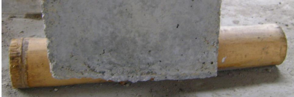
Fig. 3.17 – Teste de compressão perpendicular às fibras do bambu [32]
