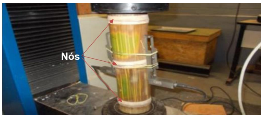
Fig. 3.18 – Teste de compressão paralelo às fibras do bambu [32]
