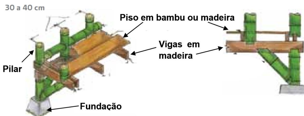
Fig. 6.12 Piso elevado com estrutura mista [48]
