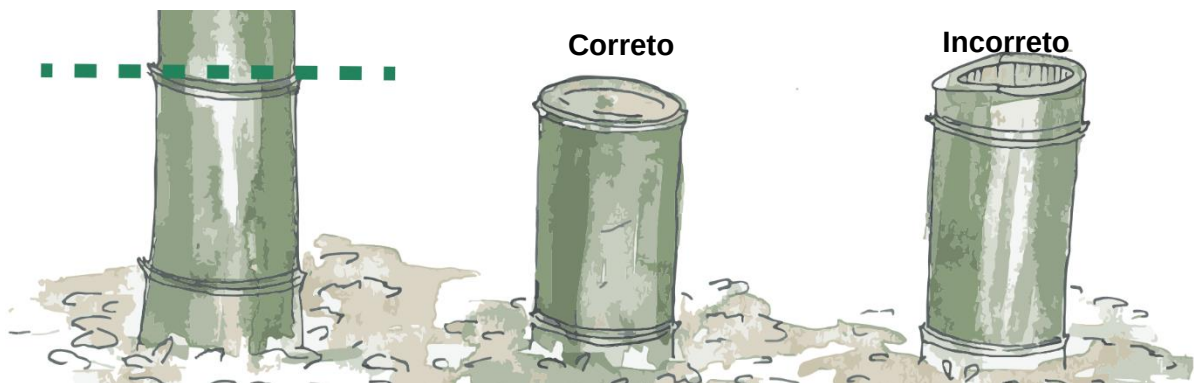
Fig. 4.11 – Corte correto e incorreto do bambu [38]
